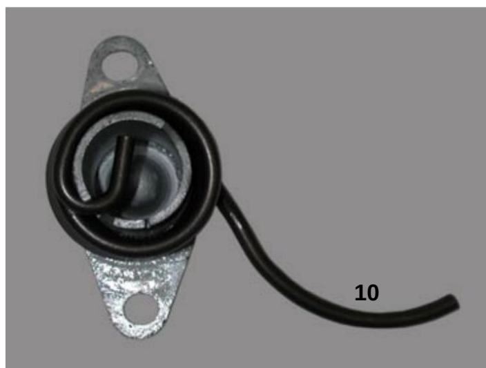
Fig. 41: Mola de compensação de torque (10) para eixo excêntrico
