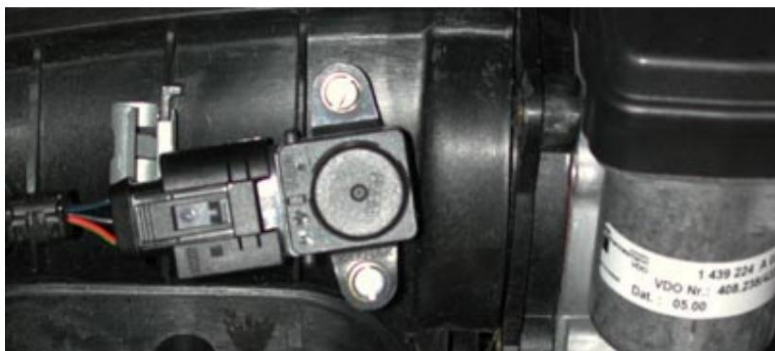
Fig. 5: Sensor de pressão no sistema de admissão
