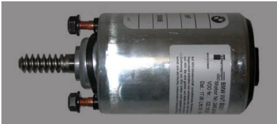
Fig. 9: Motor elétrico para ajuste do eixo excêntrico
