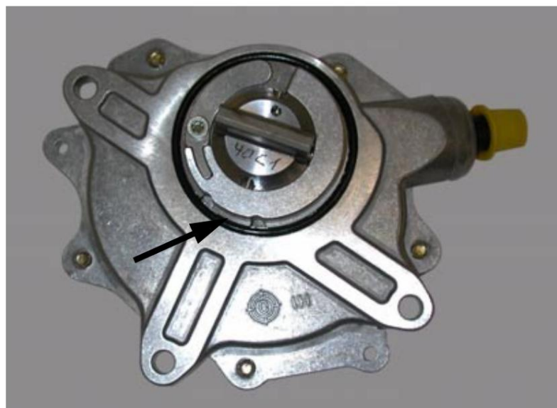
Fig. 47: Bomba de vácuo (seta = orifício de alimentação para lubrificação)
