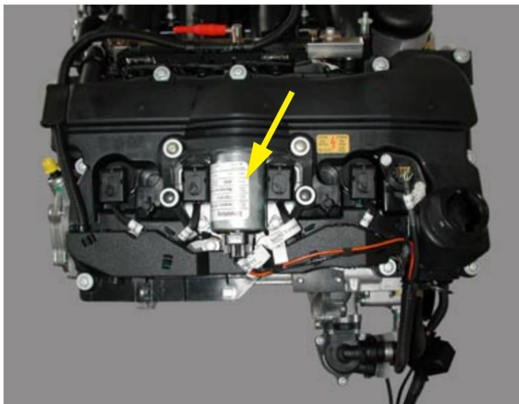
Fig. 31: Motor elétrico para ajuste do eixo excêntrico
