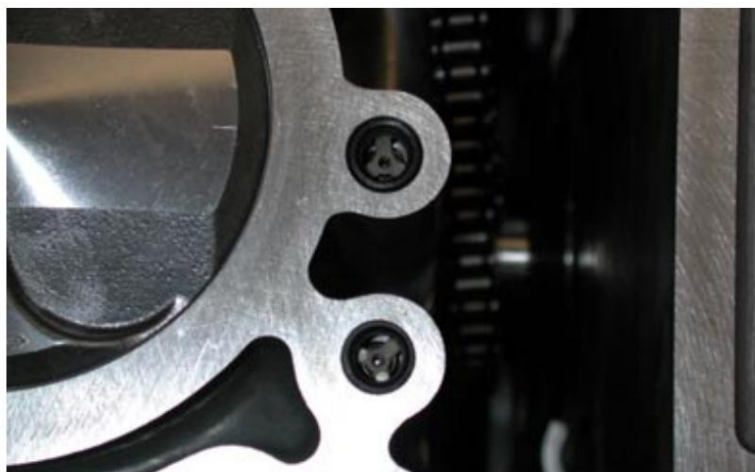
Fig. 78: Válvulas anti-retorno (12) na galeria de óleo
