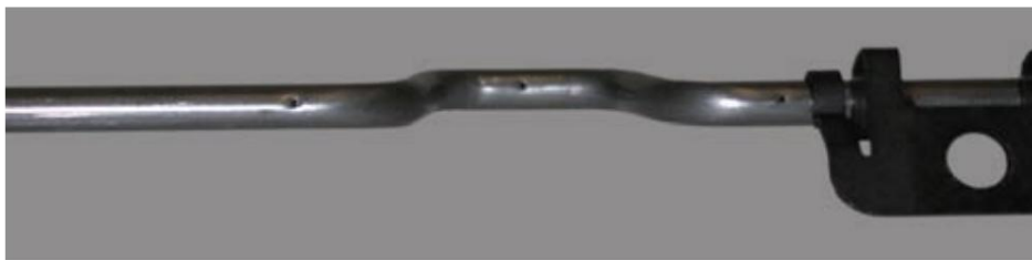
Fig. 86: Bicos de pulverização de óleo para lubrificação da árvore de comando e do eixo excêntrico
