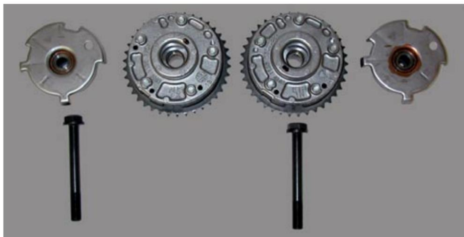
Fig. 21: VANOS com engrenagens sensoras e parafusos de montagem
