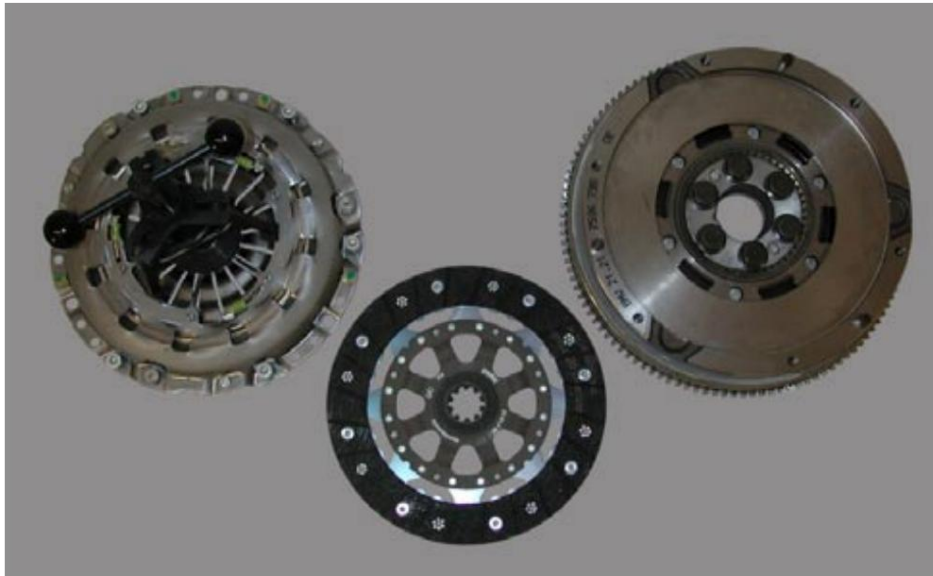
Fig. 2: Embreagem autoajustável N42 removida com volante bimassa
