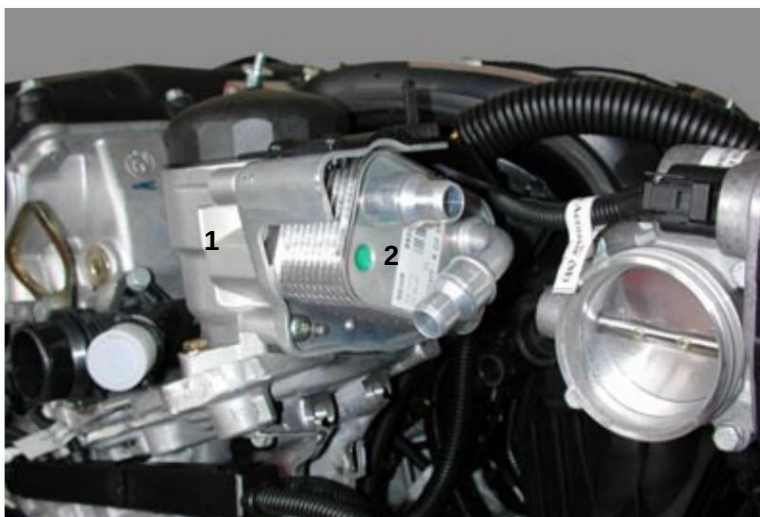
Fig. 83: Filtro de óleo (1) com trocador de calor óleo-água (2)
