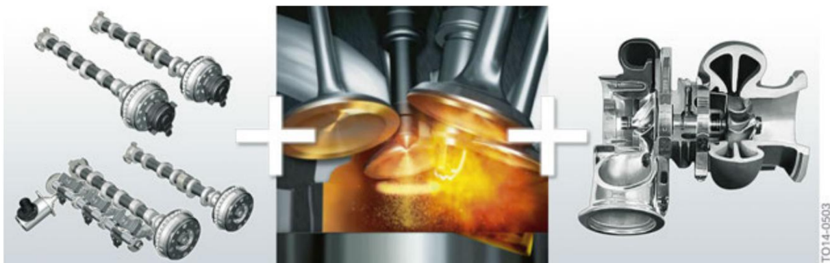
Tecnologia TwinPowerTurbo, motor B46
