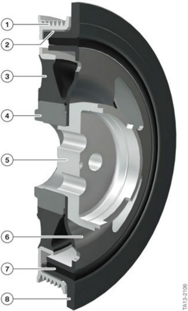
Variante amortecedor de vibração torsional, motor B46
