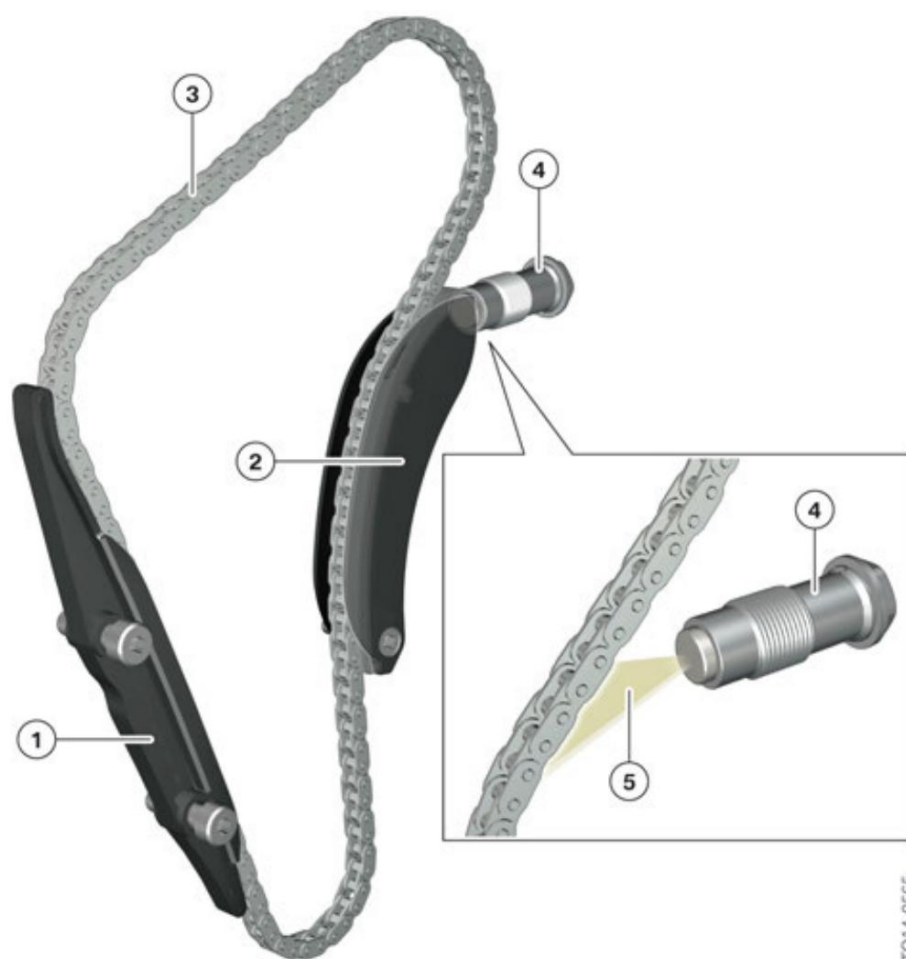
Lubrificação da corrente superior, motor B46
