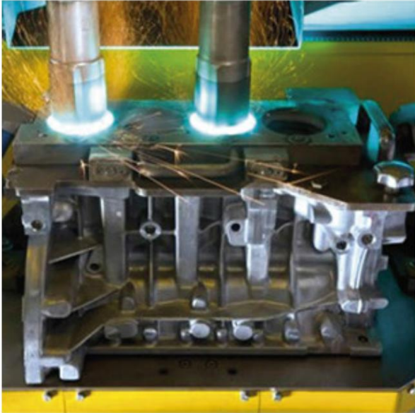
Método de pulverização de fio de arco elétrico, motor Bx8
