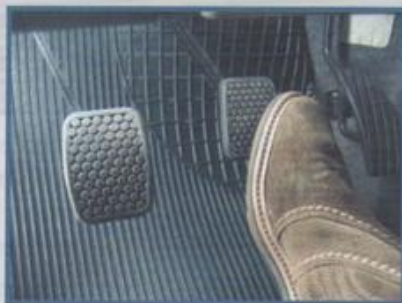
Freio acionado - Sensor do pedal de freio ativado
