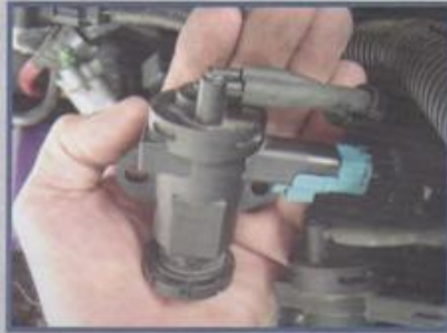
Eletroválvula de acionamento da wastegate (turbo)
