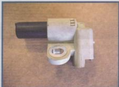
Sensor de fase capta sinal da polia ou do eixo do comando
