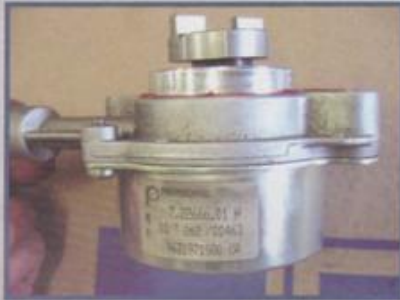
Detalhe de uma bomba de vácuo
