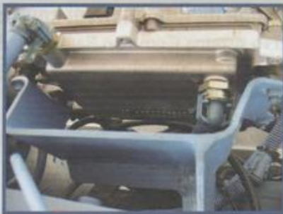
UCE refrigerada com óleo diesel
