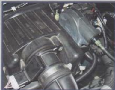
A proximidade dos sensores de massa e TPS provoca código de falha
