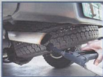
Medir os níveis de poluentes da descarga
