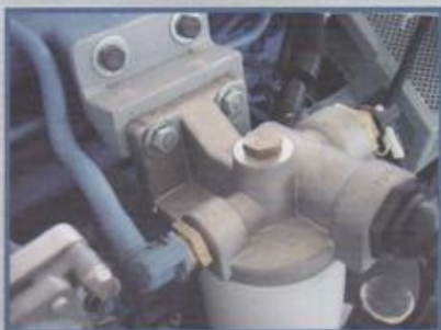
Filtro do motor MWM da VW não possui pré-aquecedor de combustível
