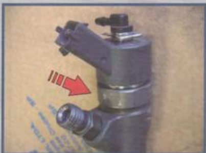
A Bosch recomenda não remover o solenóide do bico injetor para não descalibrar o componente
