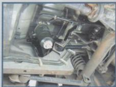
Por segurança, a GM instalou mais um filtro de óleo diesel
