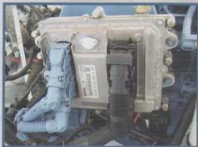
UCE fixada no motor MWM
