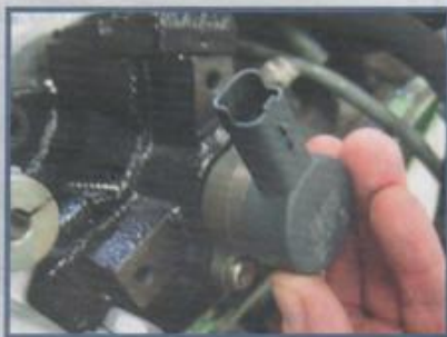
Detalhe da remoção da válvula de controle de pressão
