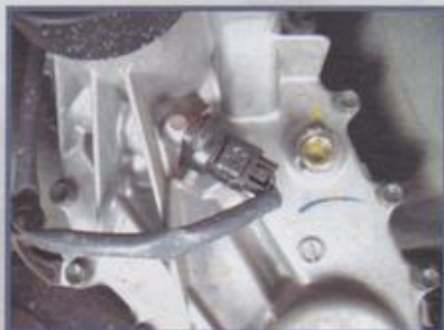
Sensor de velocidade na saída da caixa de marcha
