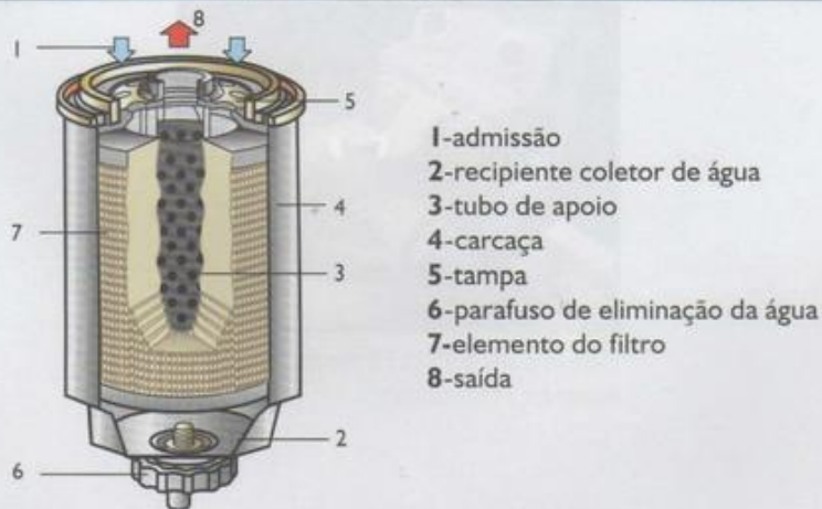
Filtro de diesel com separador de água
