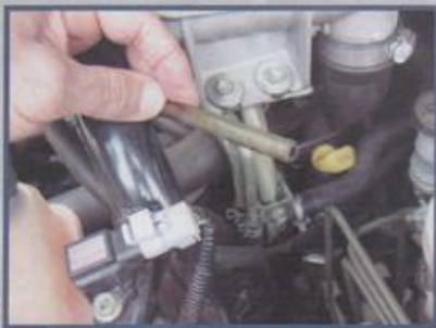
Mangueira do sensor de pressão positiva desconectada
