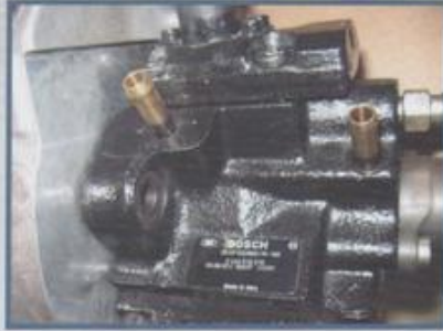
Detalhe dos tubos existentes na bomba - entrada e retorno
