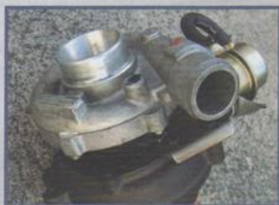
Turbina de geometria variável utilizada em alguns motores
