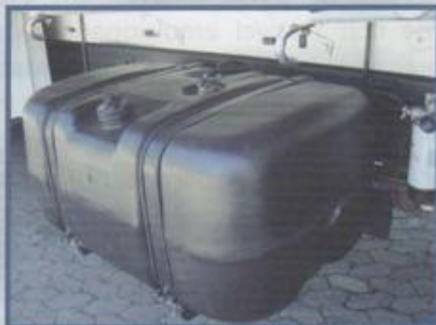
Tanque de combustível em material plástico
