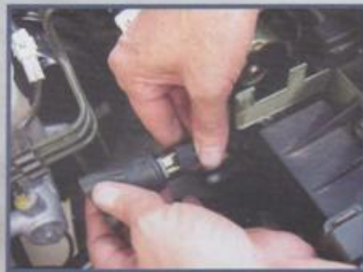
Atenção com as bases dos relés - oxidação (veículo Tracker GM)
