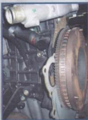
Roda fônica no volante do motor (60 dentes menos 2) Tracker
