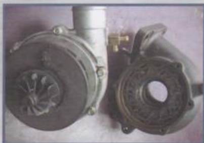
A parte quente da turbina aloja as aletas variáveis
