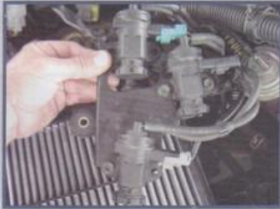
Eletroválvula de controle de vácuo - Tracker da GM
