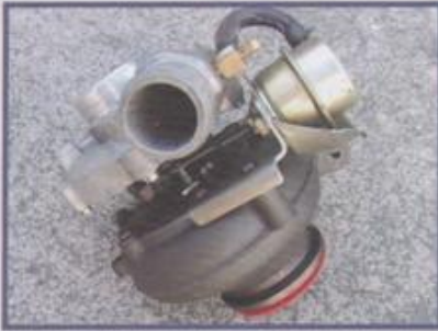
Na turbina TGV, não existe a válvula wastegate
