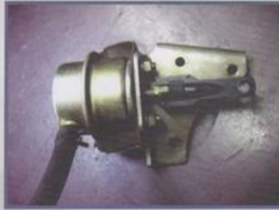
Atuador das aletas na turbina TGV
