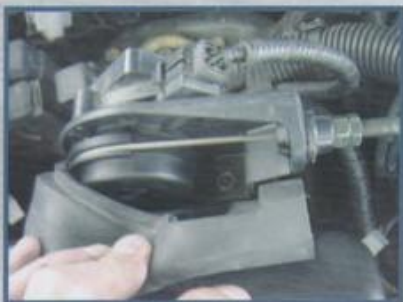
No Tracker, a unidade aceleradora opera segundo princípio hall
