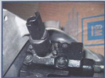
Detalhe do solenóide que desativa o elemento
