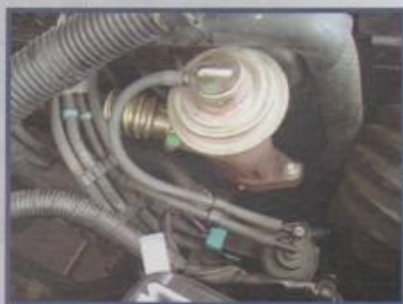
Válvula EGR de controle de NOx
