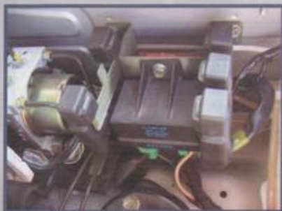
Localização do relé de acionamento da vela, no Tracker
