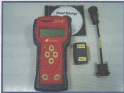
Scanner para acessar o programa de falhas do sistema Common Rail
