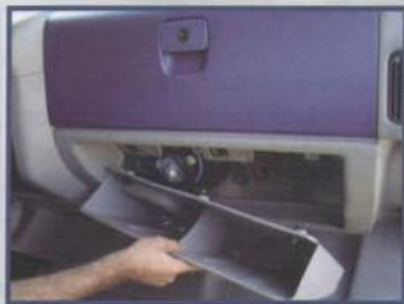
Conector de diagnose do caminhão VW atrás do porta-luvas
