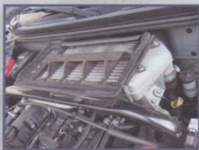
Intercooler para resfriar o ar aquecido pela pressão da turbina e contato com partes quentes do motor
