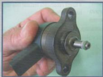
Válvula reguladora de pressão com entupimento (sujeira)
