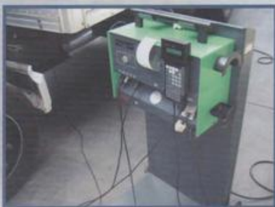
Opacímetro é um equipamento de precisão para leitura dos gases de escape
