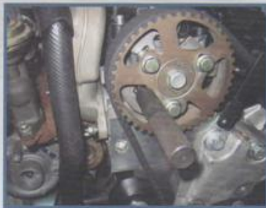
No Tracker, utiliza-se um pino para travar a polia do comando
