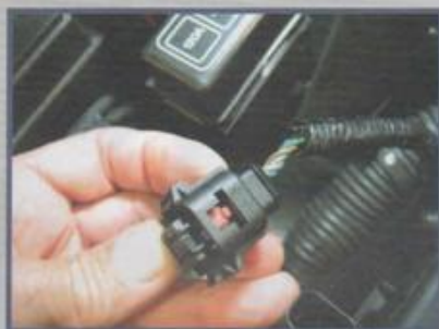
Torcer os fios do chicote auxilia contra interferências
