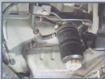
Filtro adicional para maior proteção dos componentes (Tracker)
