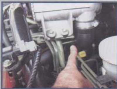
Ponto de fixação da mangueira no coletor de admissão
