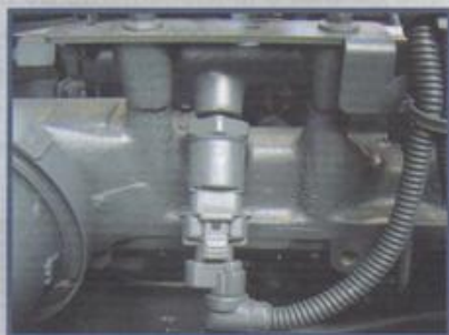
Sensor de pressão no rail conectado ao chicote elétrico
