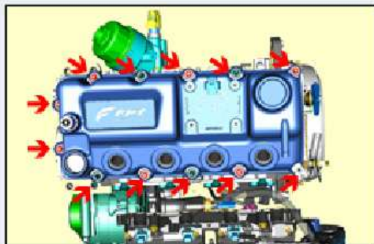
PARAFUSOS DE FIXAÇÃO DA BOBINA DE IGNIÇÃO 11,9 Nm [1,2 Kgm]
