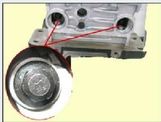
PARAFUSO DO TENSOR DA CORRENTE DE DISTRIBUIÇÃO 62,4 Nm [6,2 Kgm]
