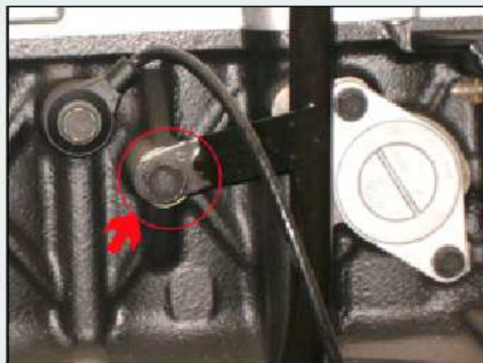
PARAFUSOS DE FIXAÇÃO DA TAMPA DE VÁLVULAS 11,9 Nm [1,2 Kgm]
