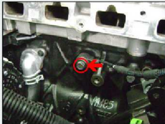
PARAFUSO DE FIXAÇÃO DO TUBO DA VARETA DE ÓLEO 9,0 Nm [9 Kgm]
