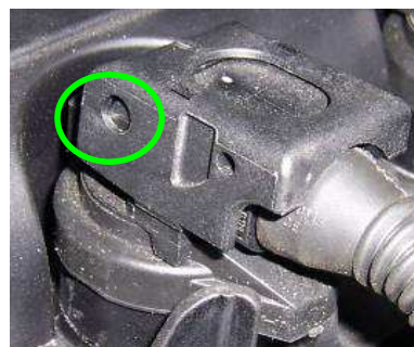
Conector mal encaixado.
