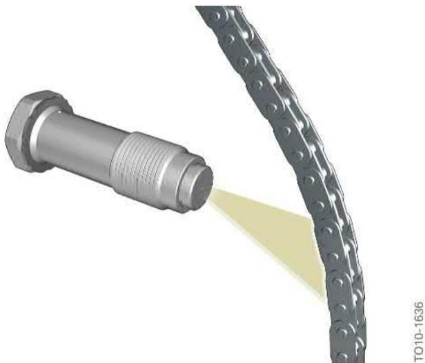
Motor N13, tensor de corrente com bocal de pulverização de óleo para corrente de distribuição
