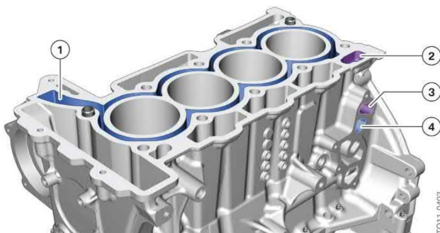
Motor N13, camisa de resfriamento e dutos de refrigerante
