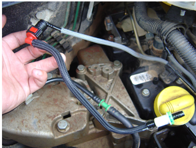
Figura 5 – Utilização da mangueira de alimentação adaptada como tampão para o retorno dos bicos injetores e da bomba CP3.
