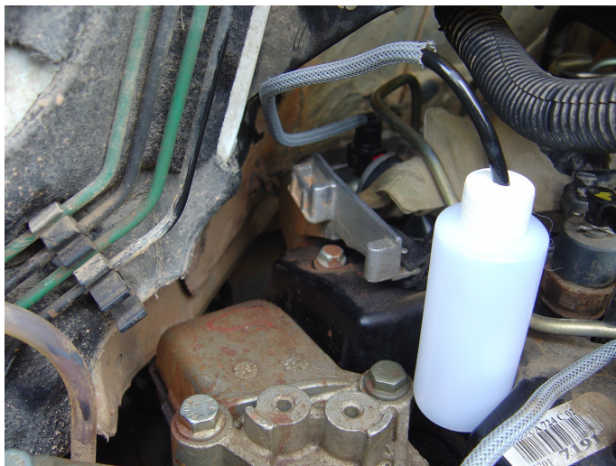
Figura 6 – Ferramenta elaborada a partir de uma mangueira de retorno conectada à rampa de injeção e a um reservatório da MOT 1711.
