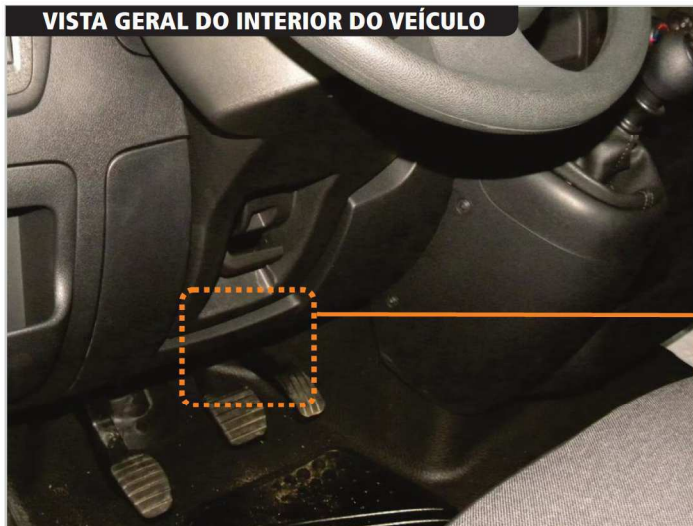
Sensor de Posição do Pedal do Acelerador: Acoplado ao pedal do acelerador.
