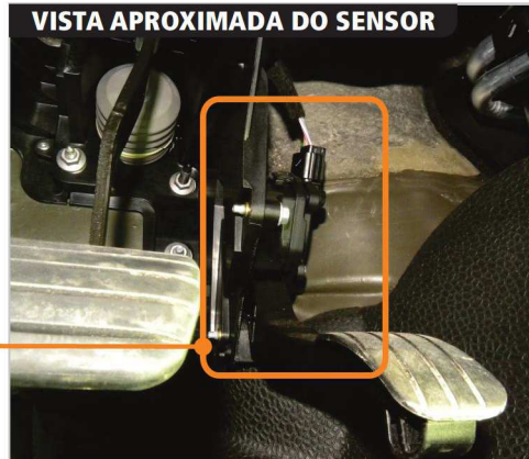
Sensor de Posição do Pedal do Acelerador: Acoplado ao pedal do acelerador.
