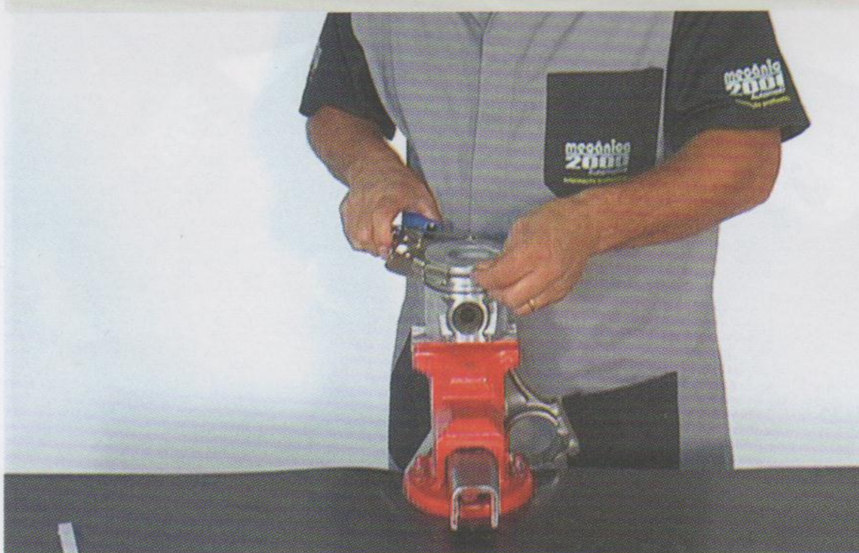
Fig.7 - Montagem do terceiro anel
