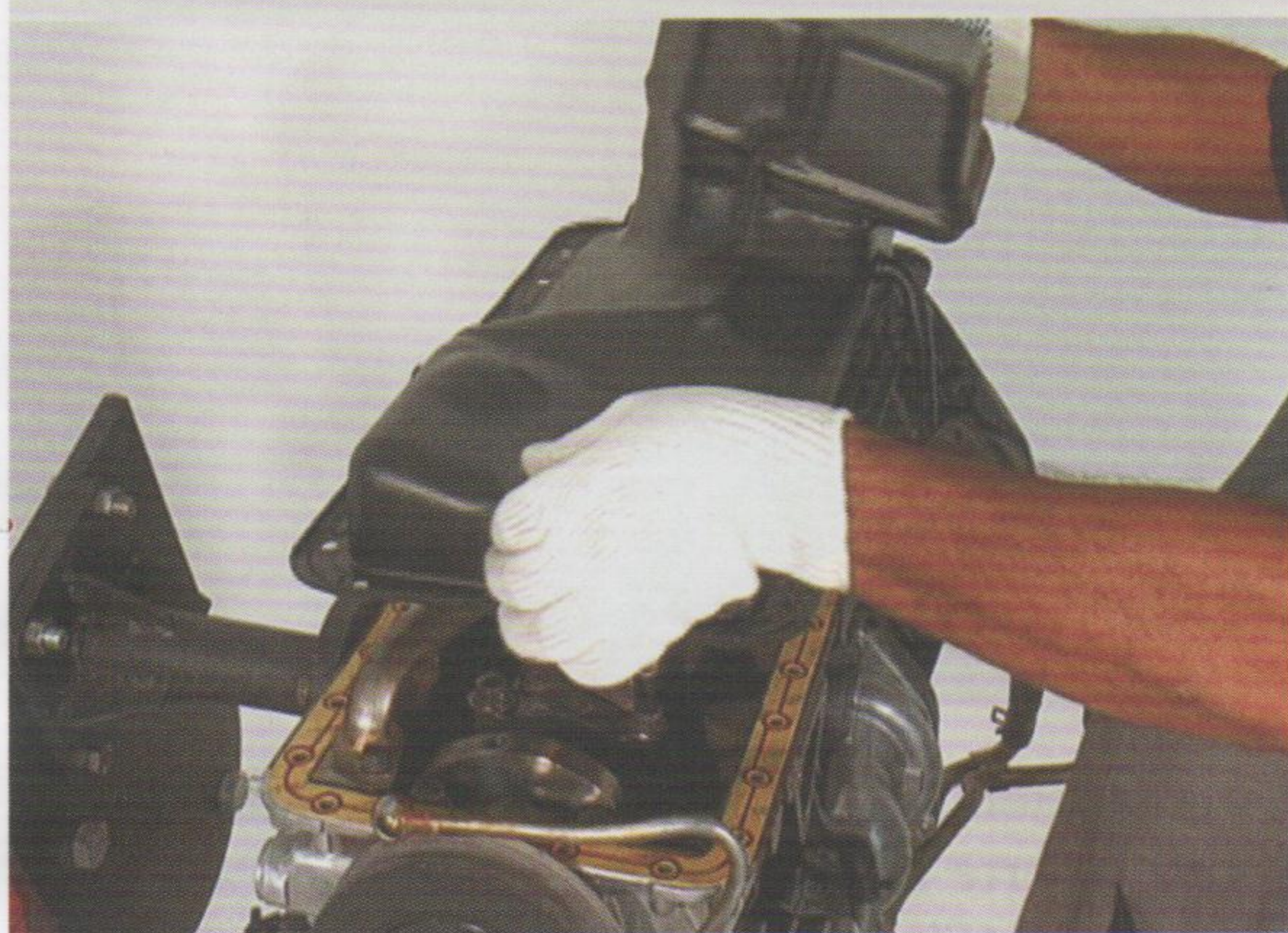
Fig.1 - Instalação do cárter
