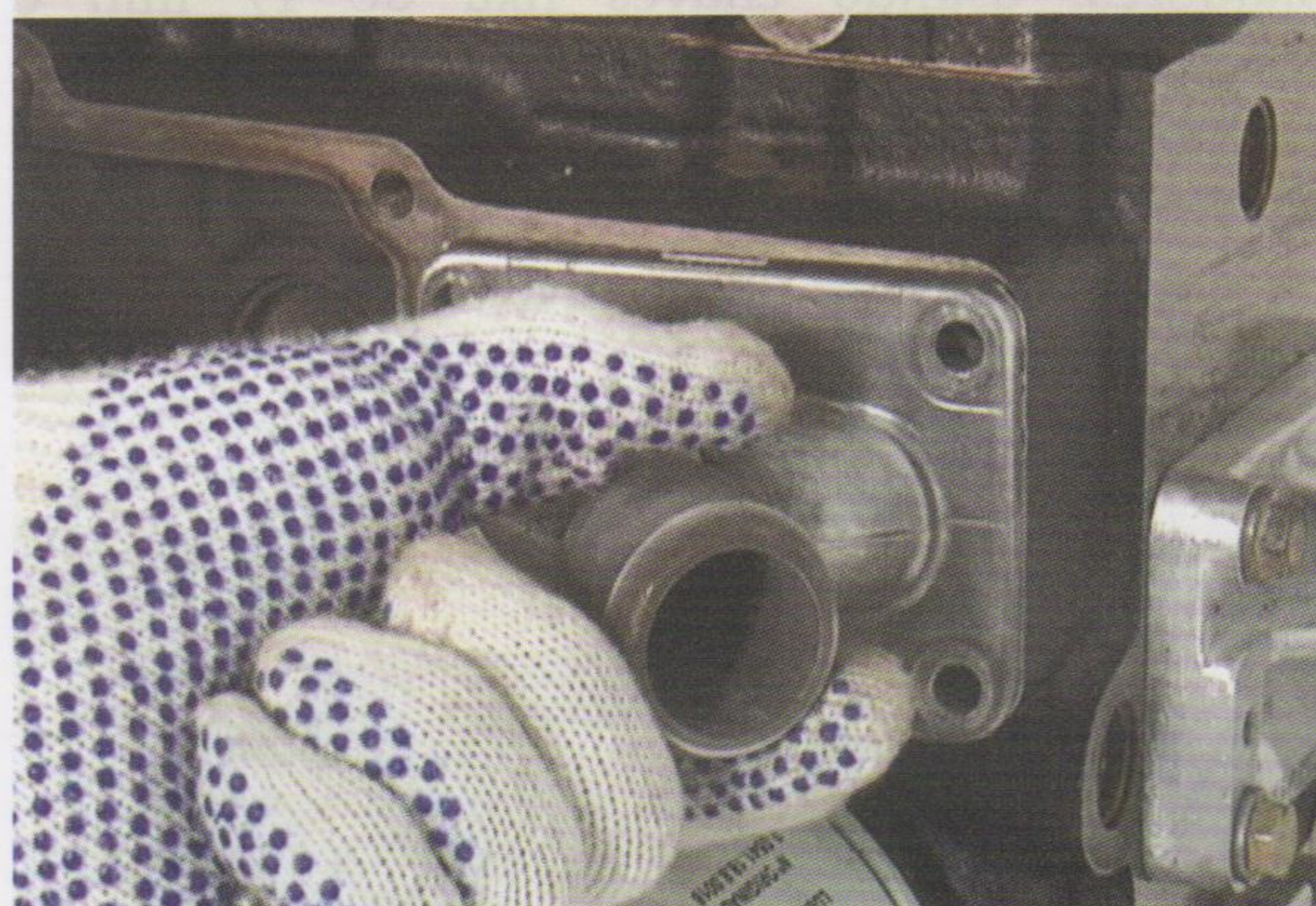
Fig.13 - Conjunto das válvulas termostáticas
