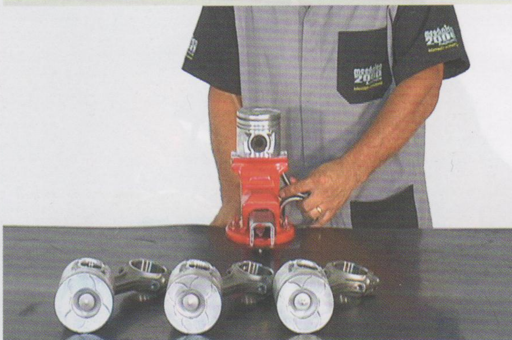
Fig.1 - Preparação para montagem dos anéis
