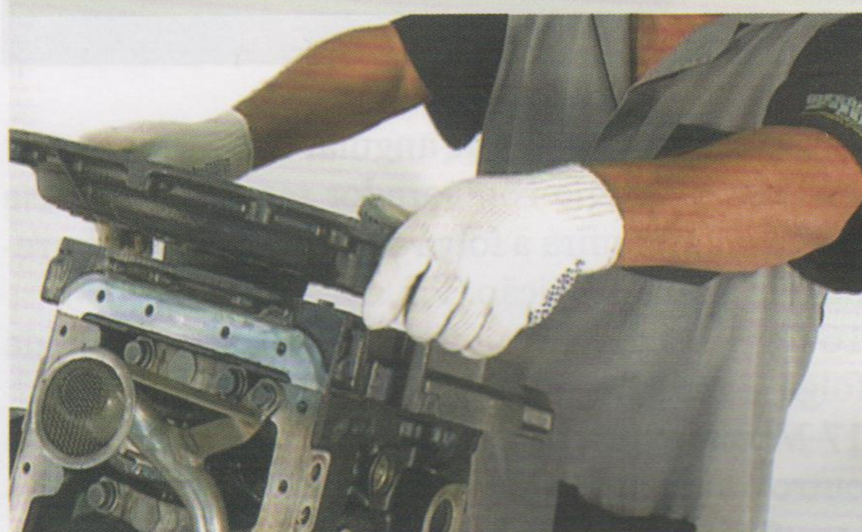
Fig.5 - Instalação da tampa de engrenagens
