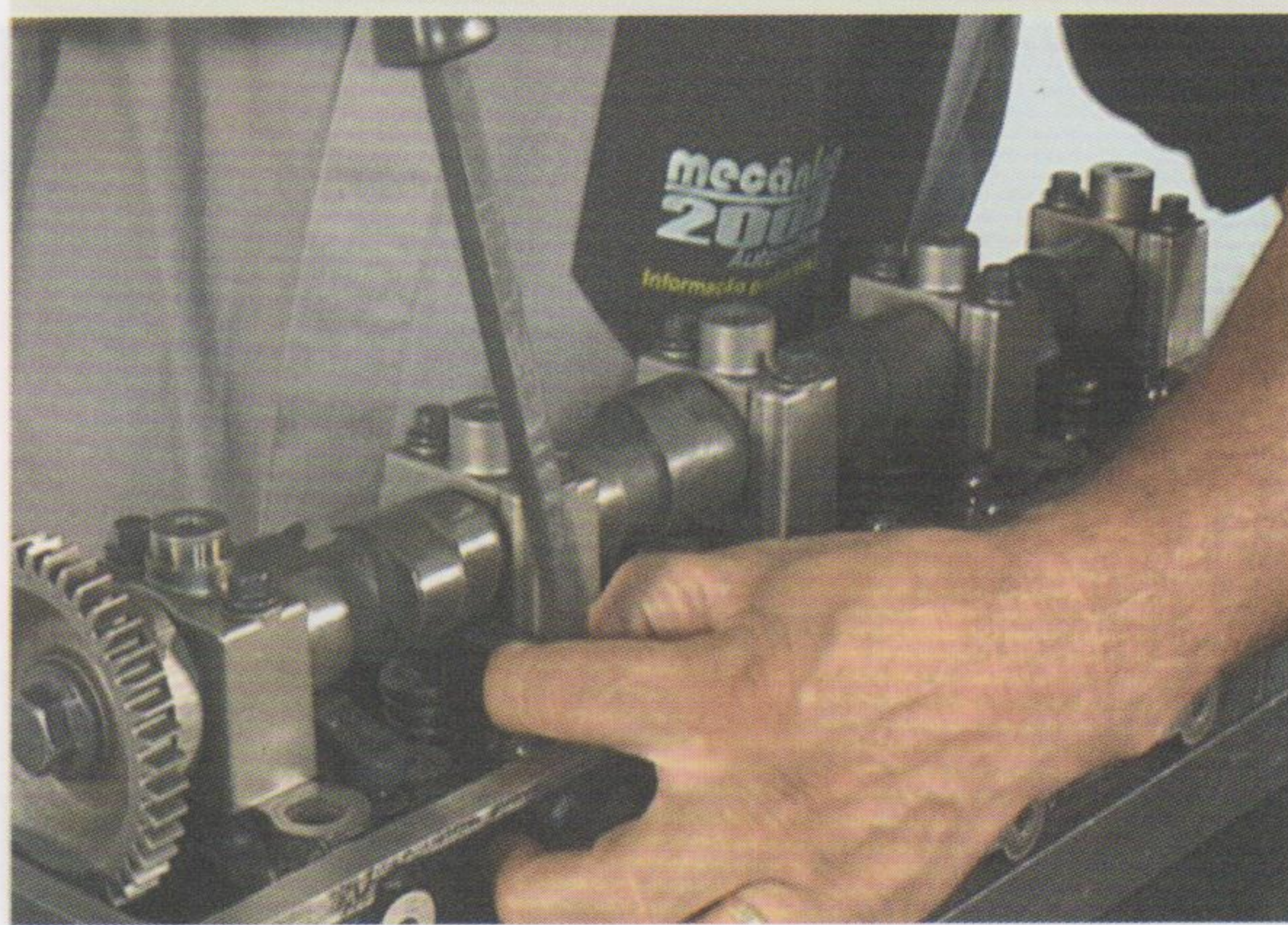
Fig.23 - Instalação dos balancins
