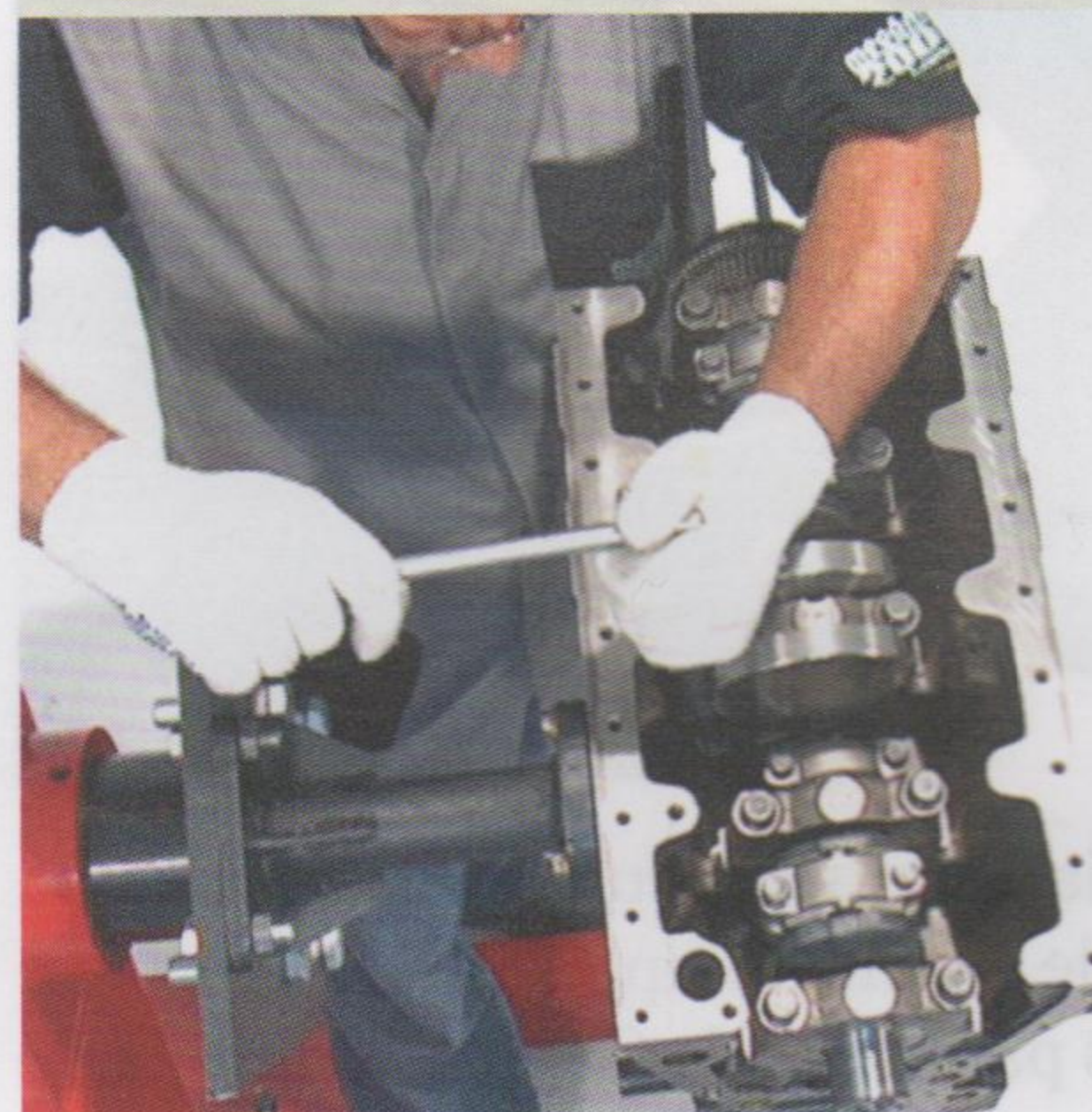
Fig.36 - Iniciando remoção dos tubos ejetores de óleo
