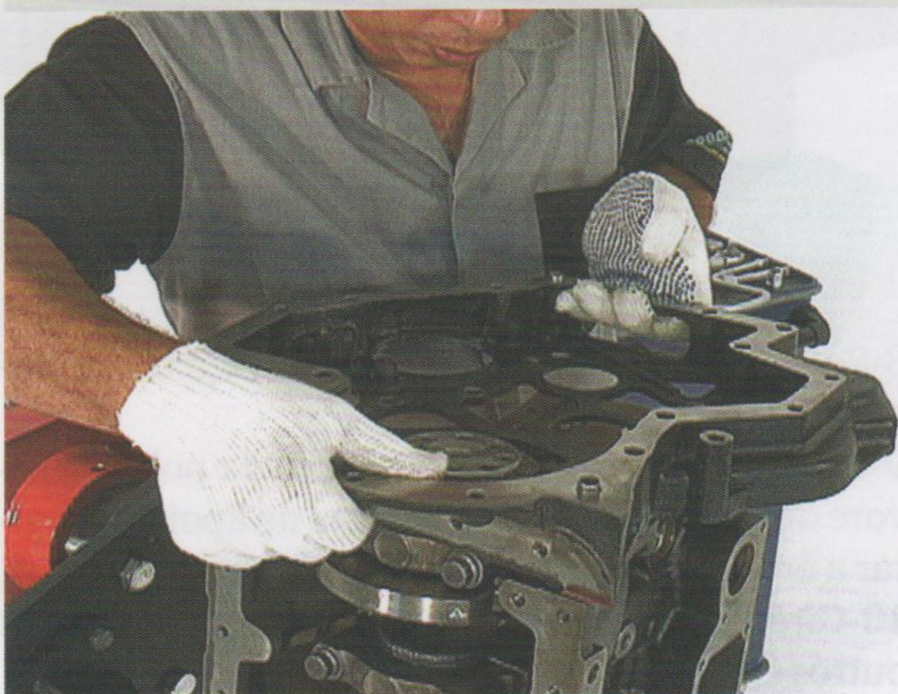
Fig.1 - Instalação do alojamento das engrenagens
