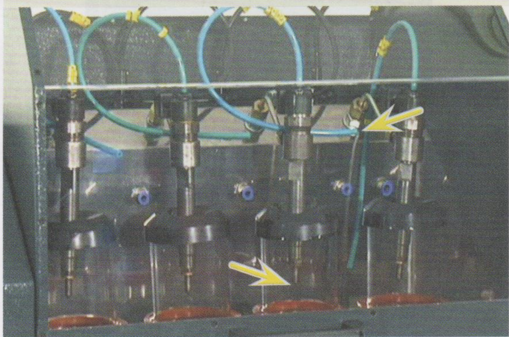
Fig.8 - Vazamento no 3º injetor
