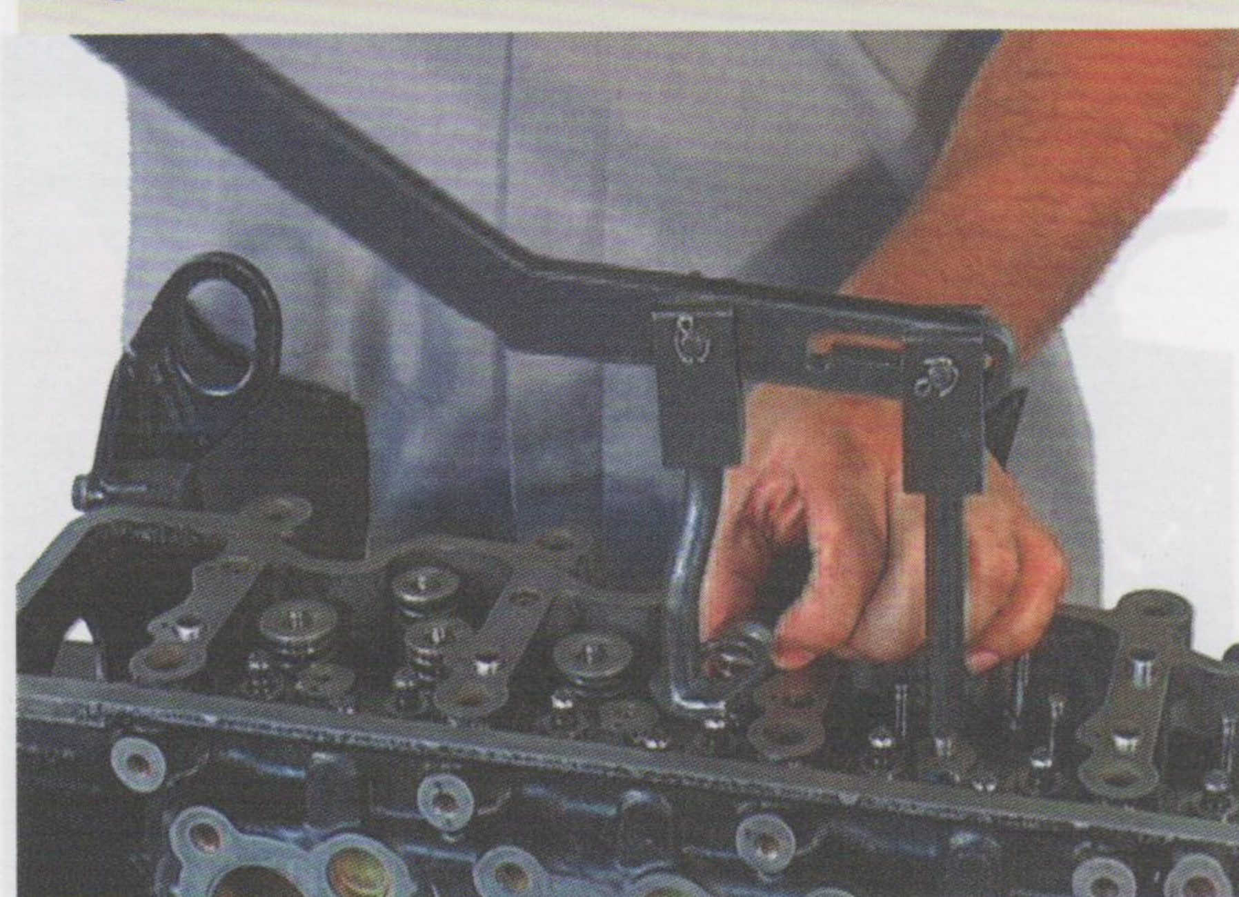
Fig.16 - Desmontagem das válvulas
