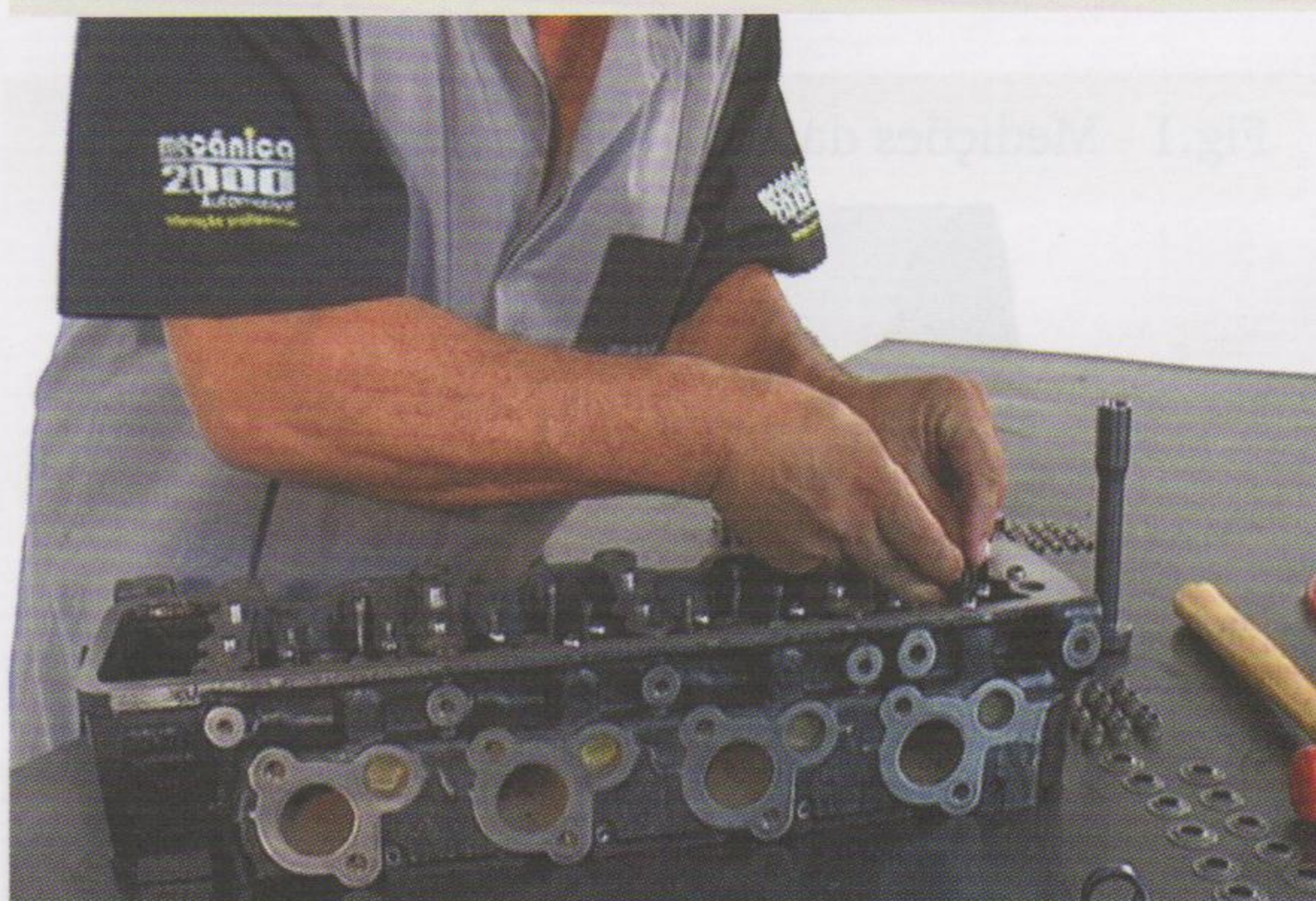
Fig.3 - Instalação dos pratos inferiores
