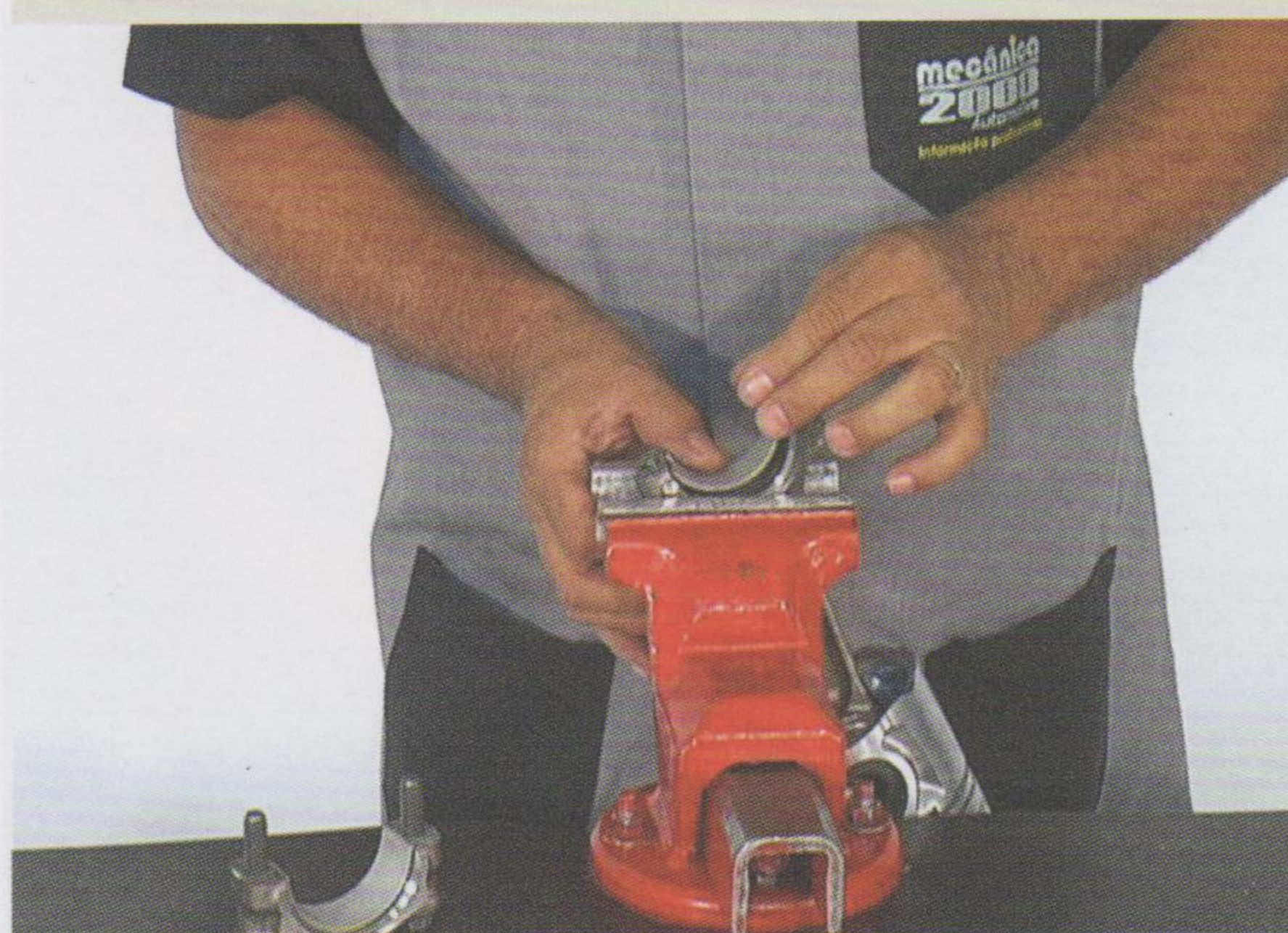
Fig.5 - Instalação dos casquilhos
