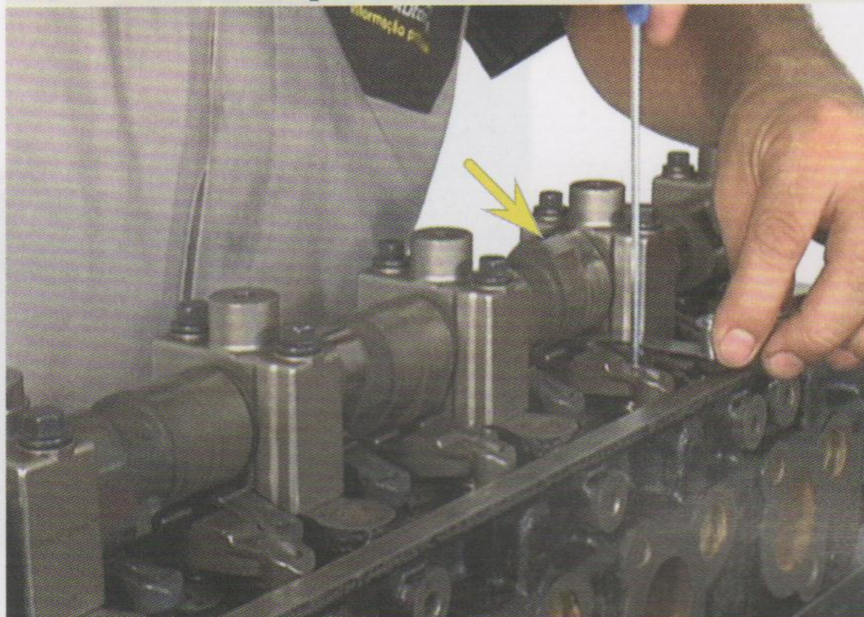
Fig.28 - Regulagem das válvulas (cames voltados para cima)
