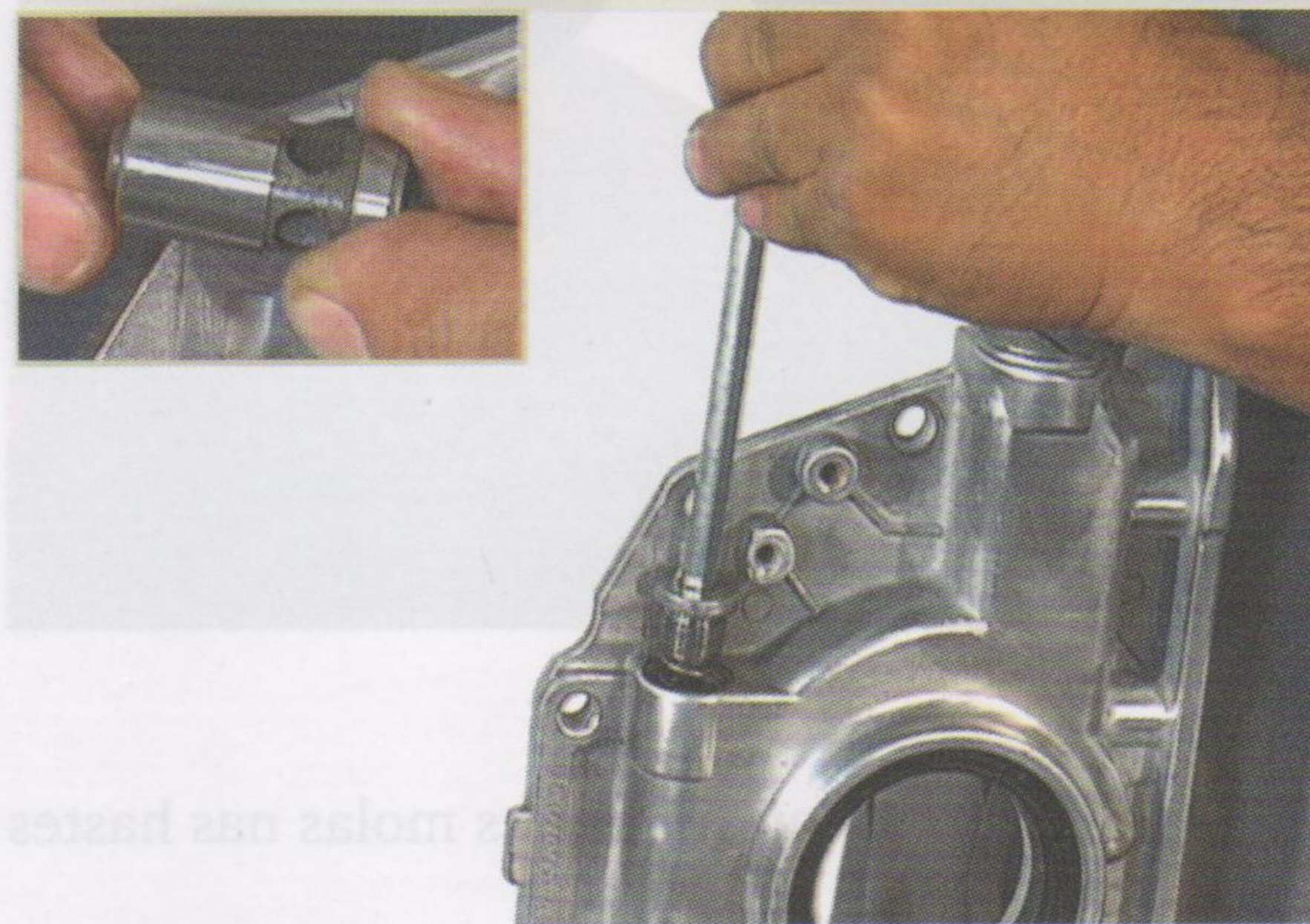
Fig.2 - Detalhe da válvula reguladora de pressão
