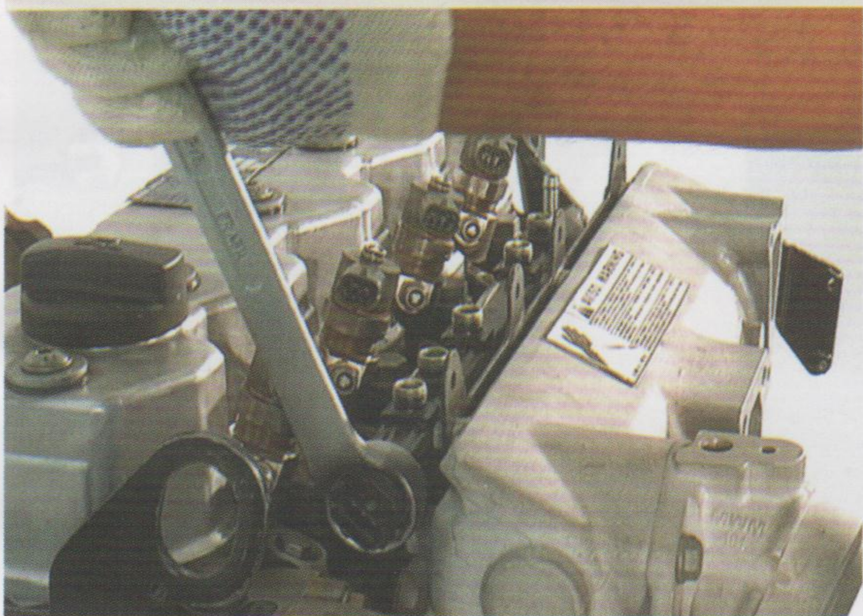
Fig.7 - Montagem/aperto do sensor
