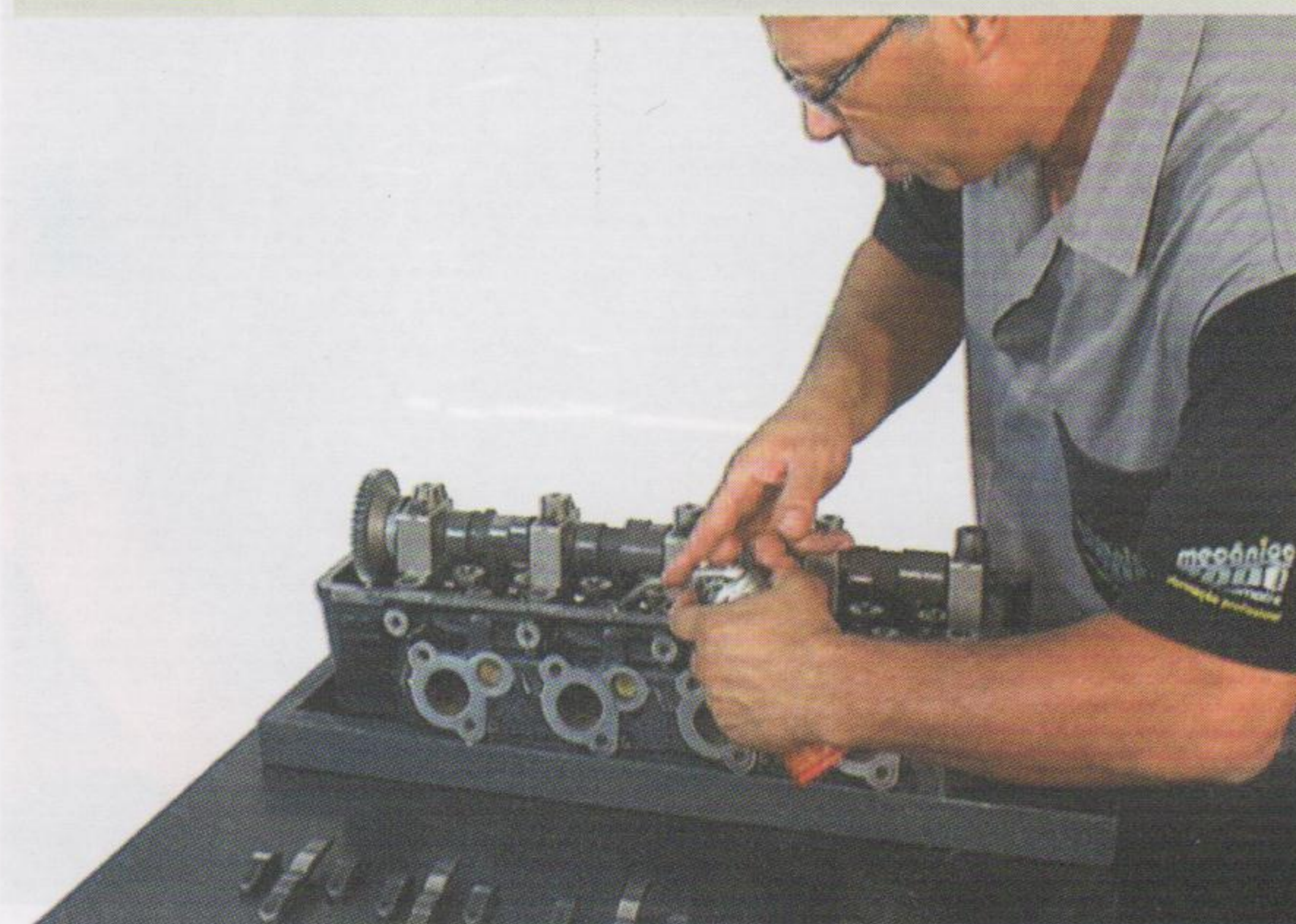
Fig.21 - Preparação para instalação dos balancins
