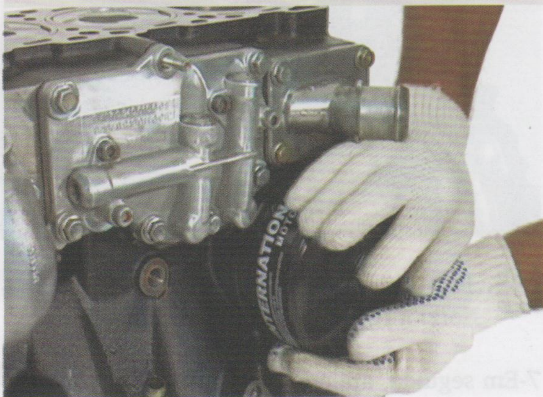
Fig.10 - Instalação do filtro de óleo
