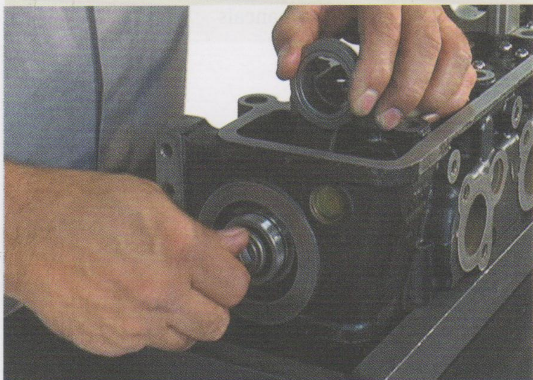
Fig.12 - Instalação da engrenagem intermediária
