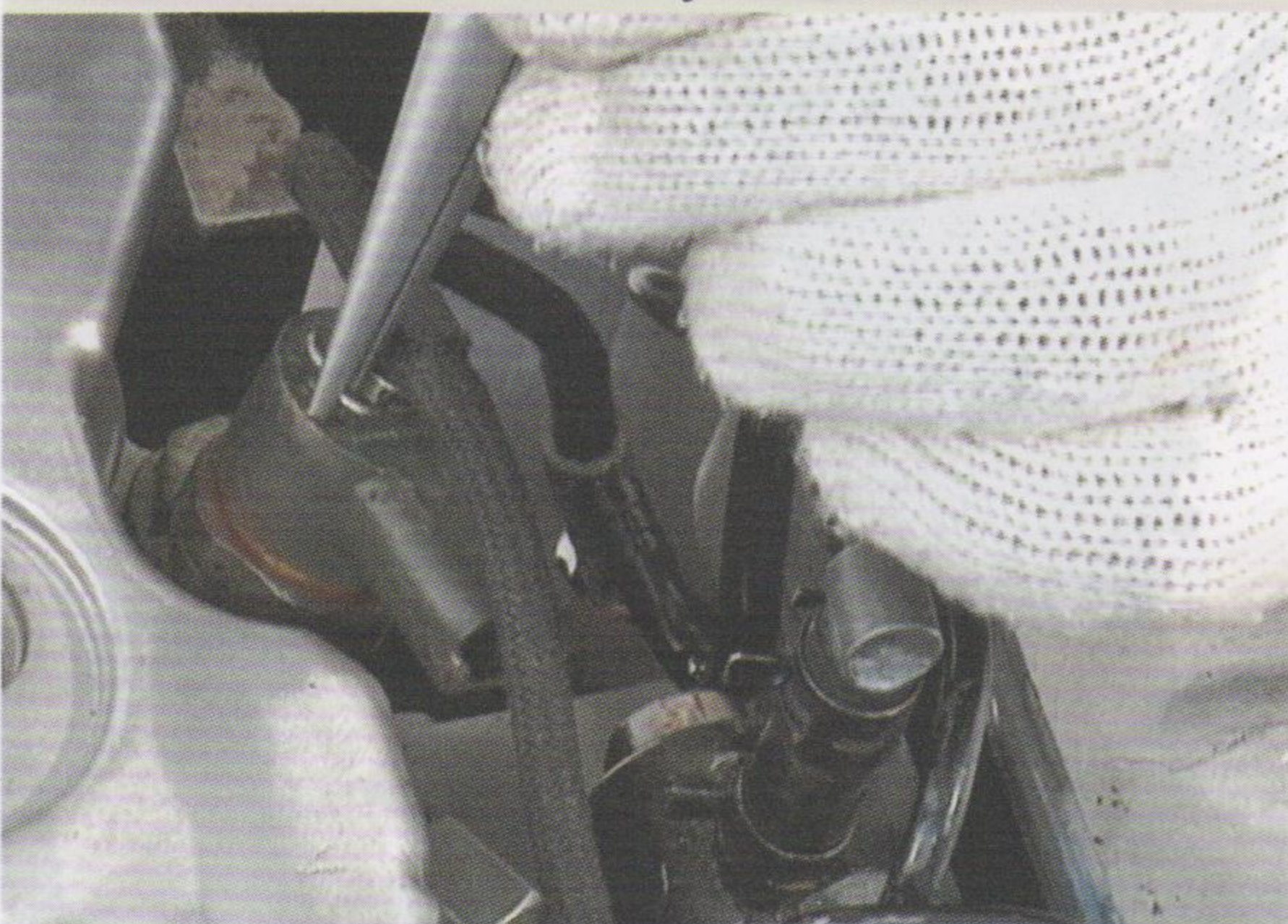
Fig.17 - Presilha de fixação da tubulação de retorno do combustível dos bicos injetores
