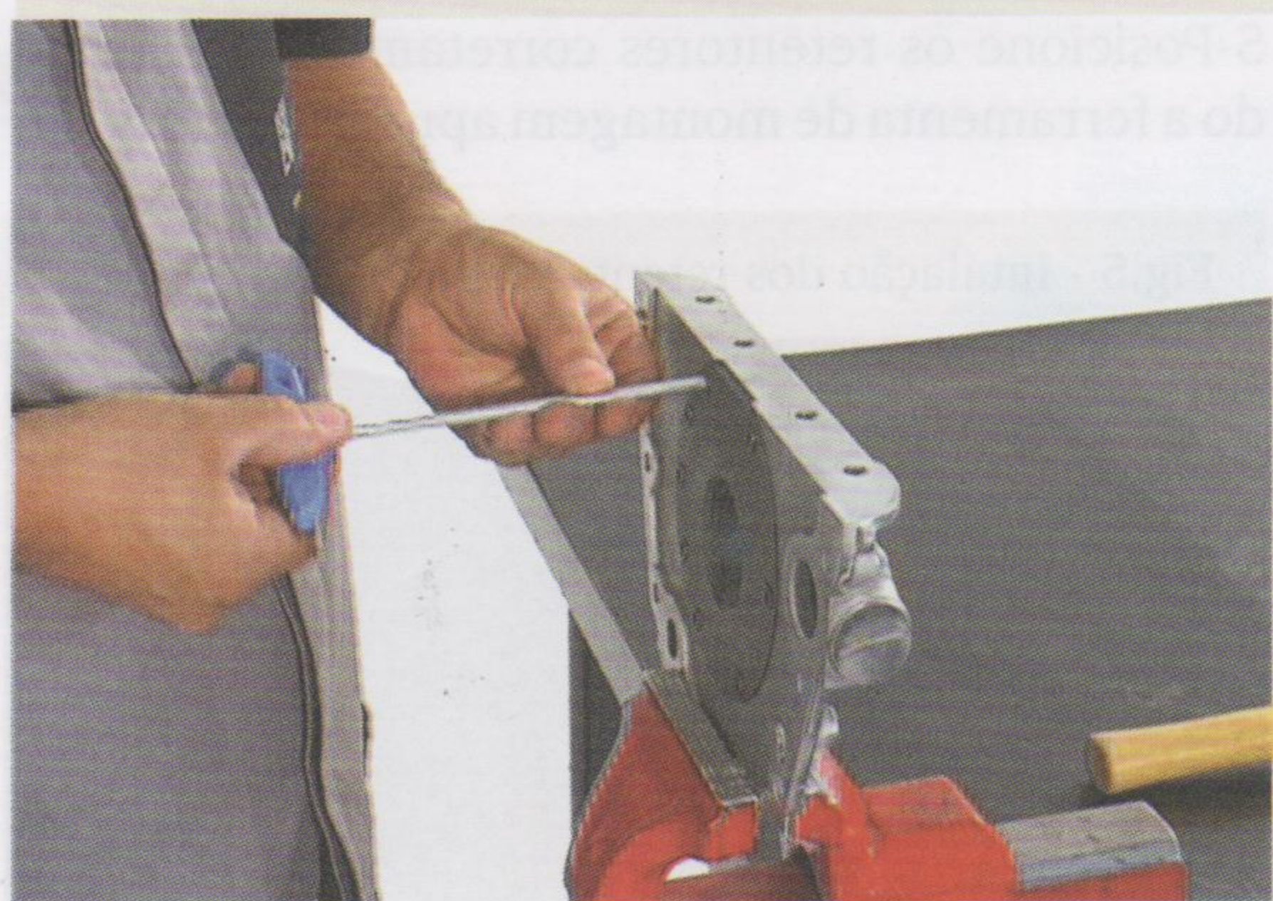
Fig.1 - Desmontagem da bomba de óleo
