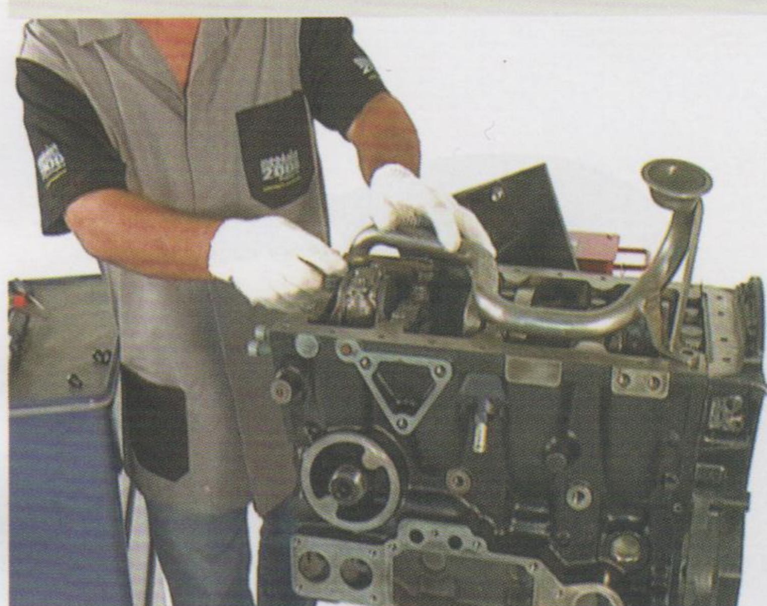
Fig.2 - Montagem do tubo pescador
