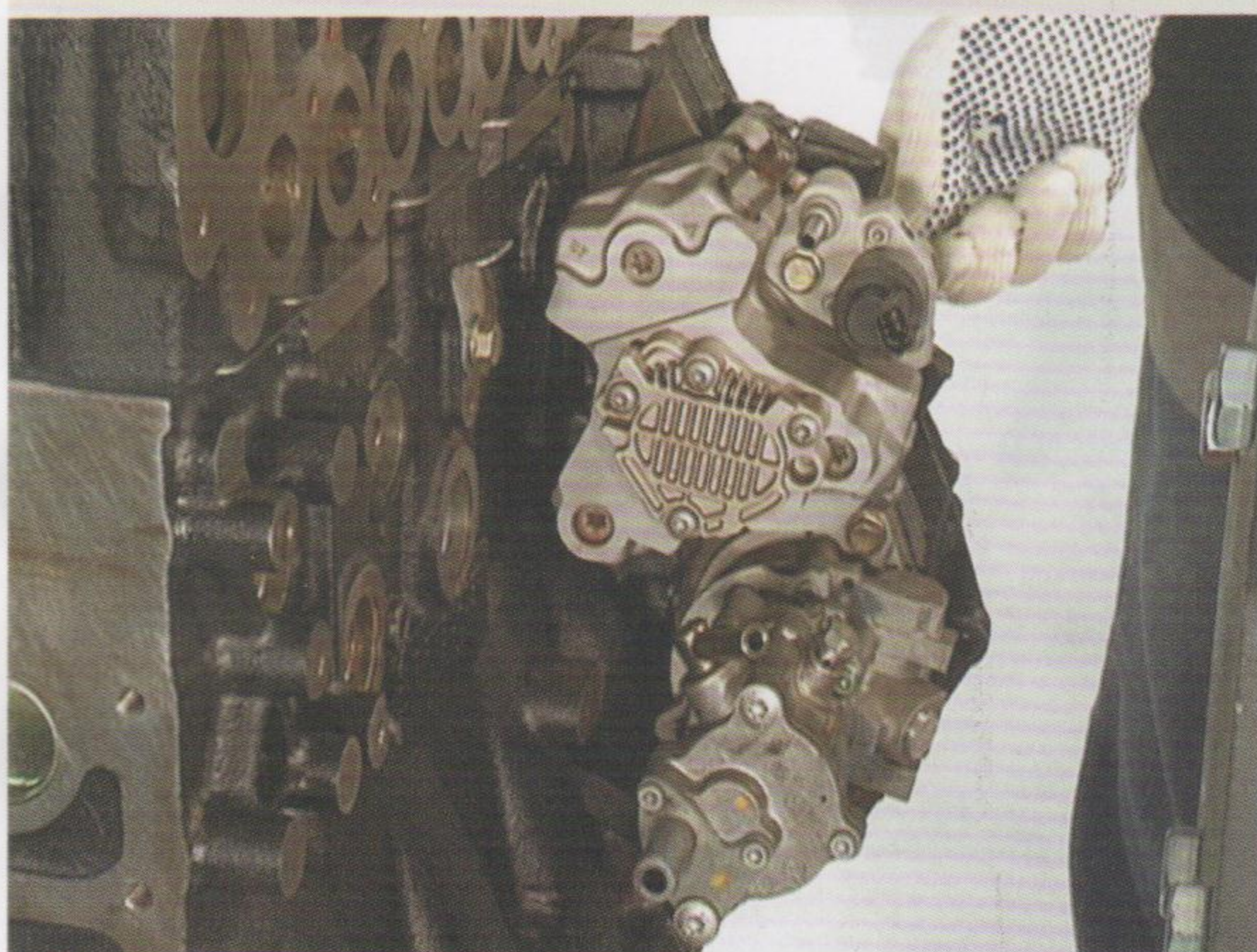
Fig.2 - Instalação da bomba de alta pressão
