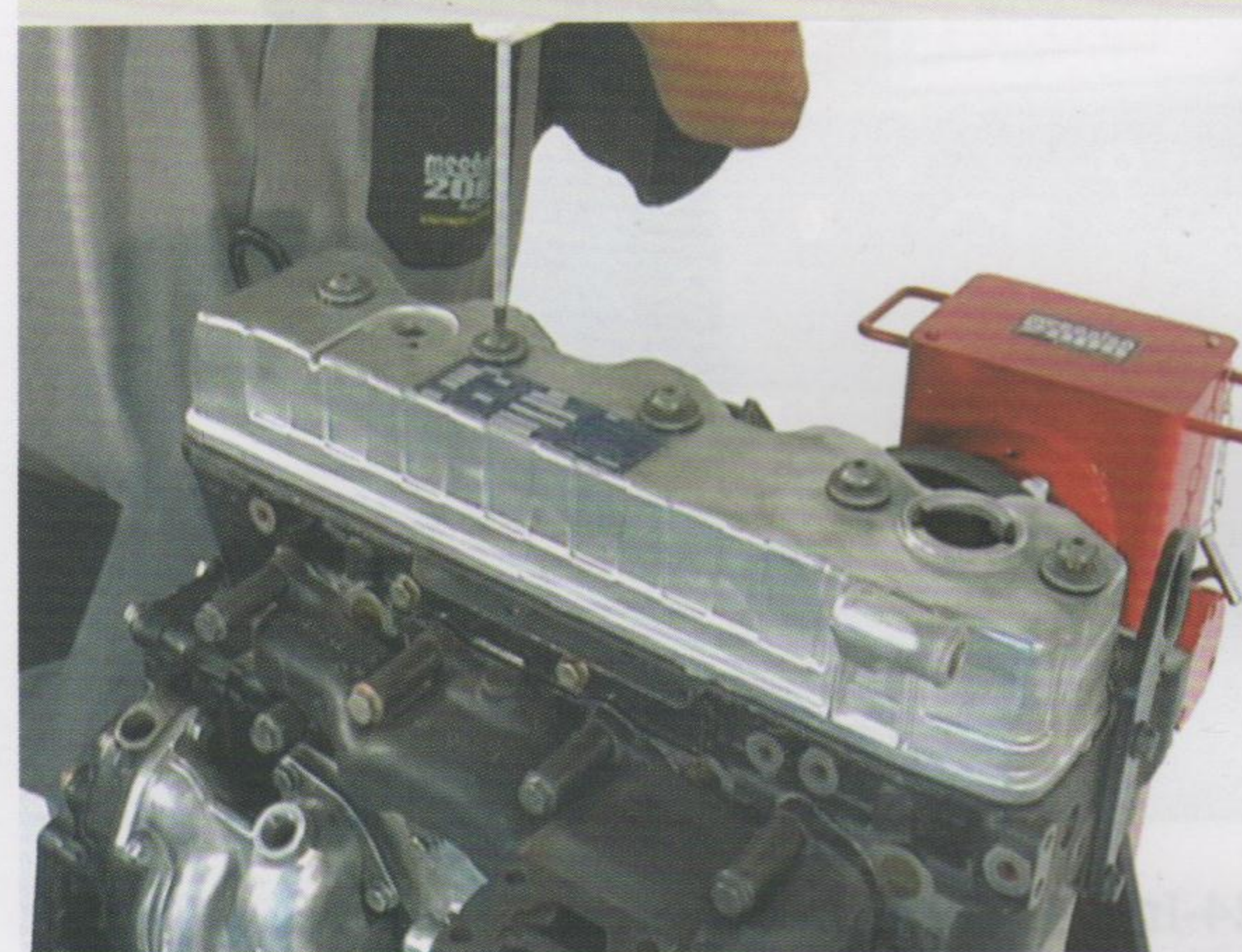
Fig.8 - Instalação da tampa de válvulas
