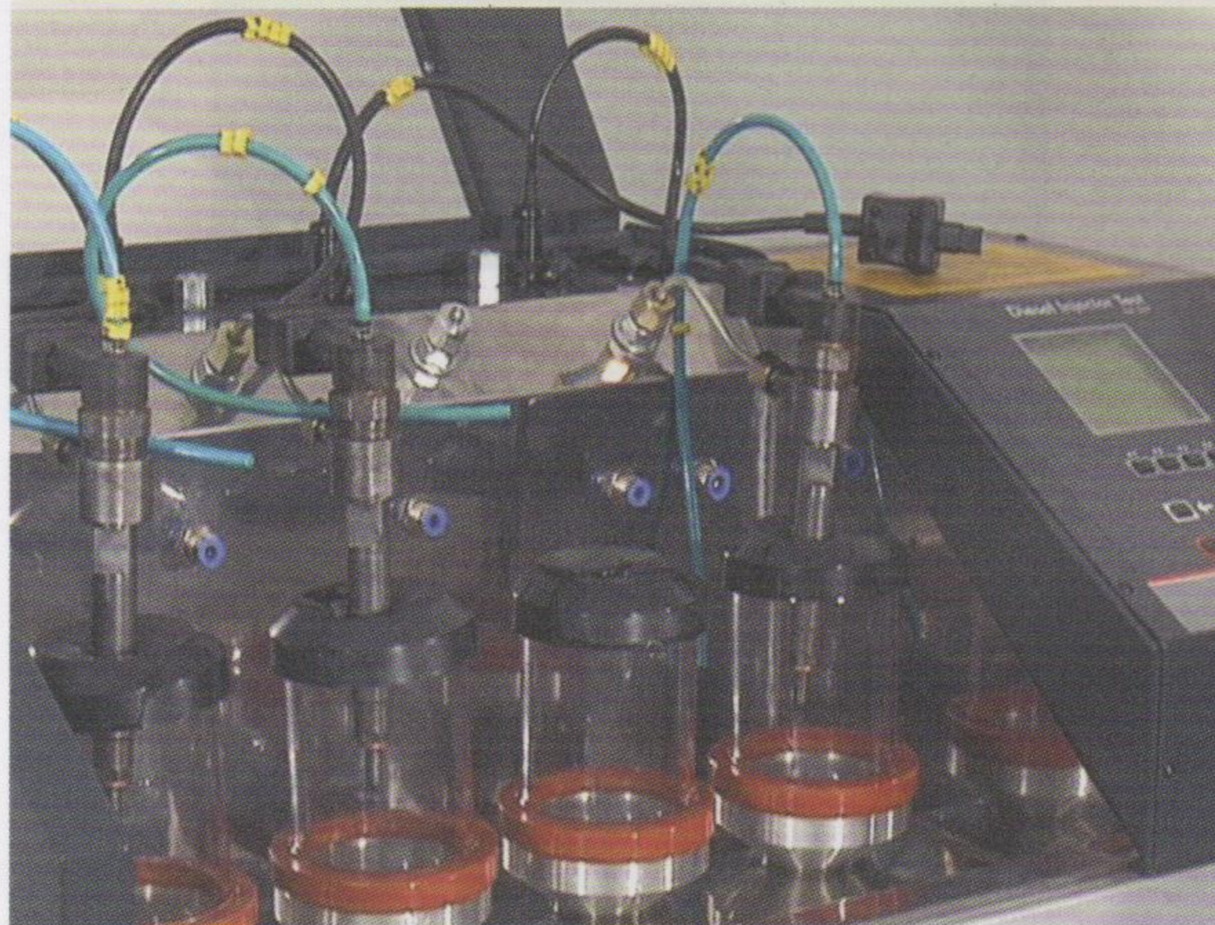
Fig.10 - Repetição do teste após remoção do bico defeituoso
