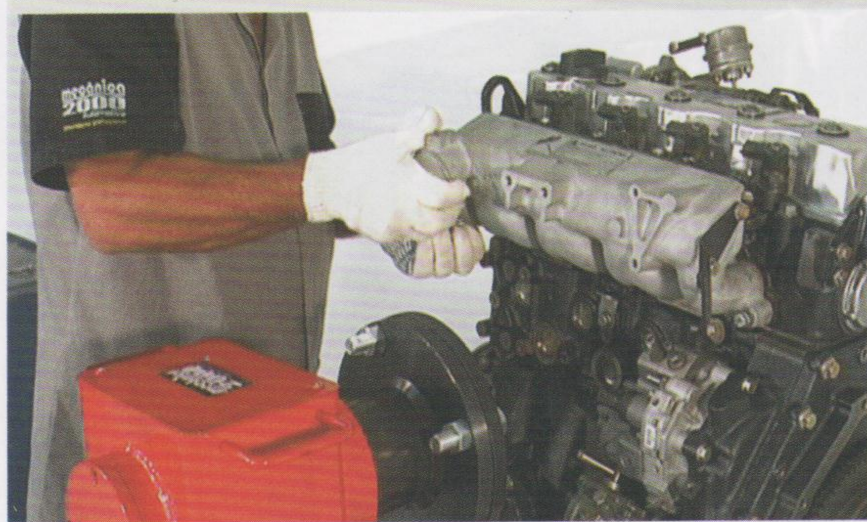
Fig.2 - Montagem do coletor com common rail
