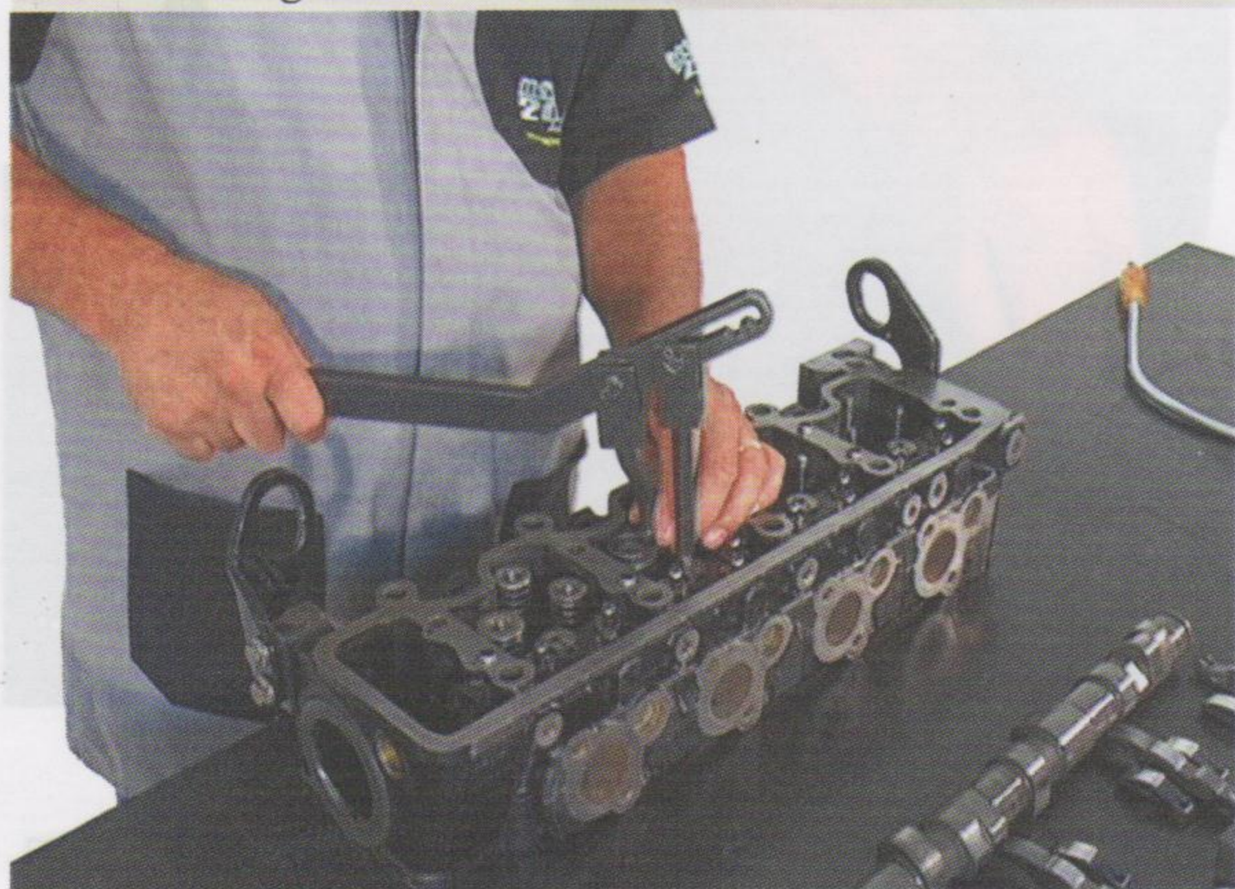
Fig.14 - Instalação da ferramenta para desmontagem das válvulas
