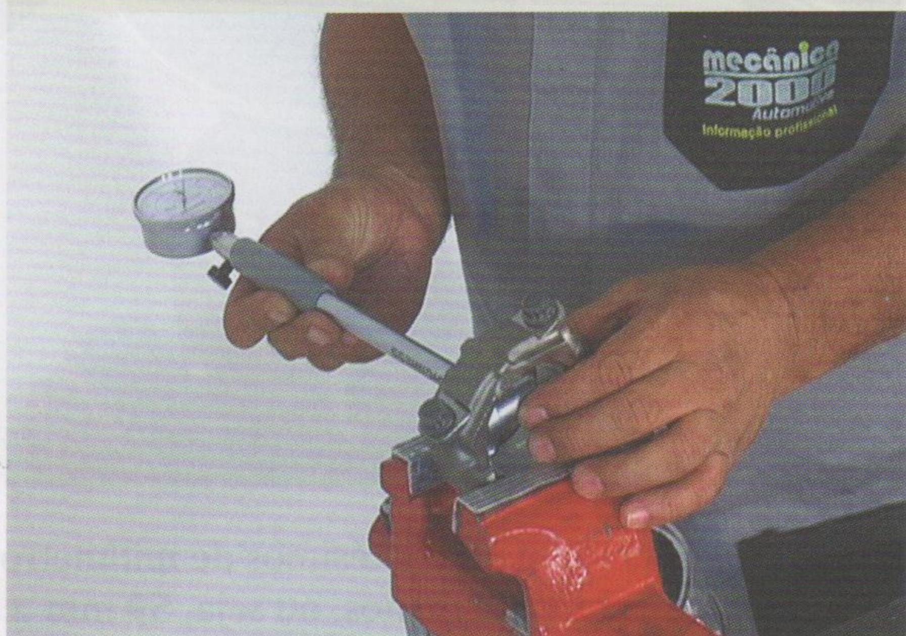
Fig.6 - Medição do alojamento da árvore de manivelas
