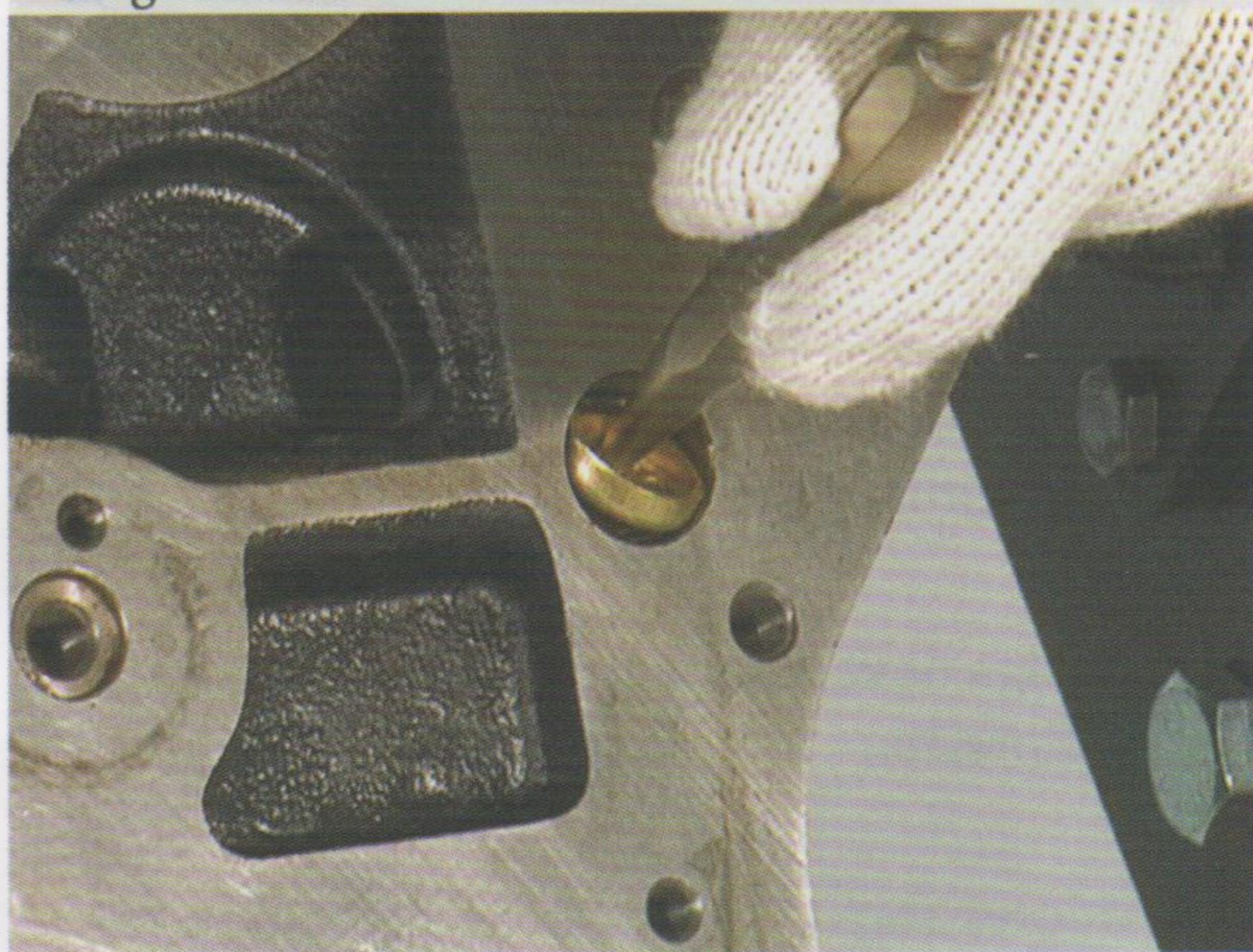
Fig.1 - Remoção do selo frontal de vedação da galeria de óleo
