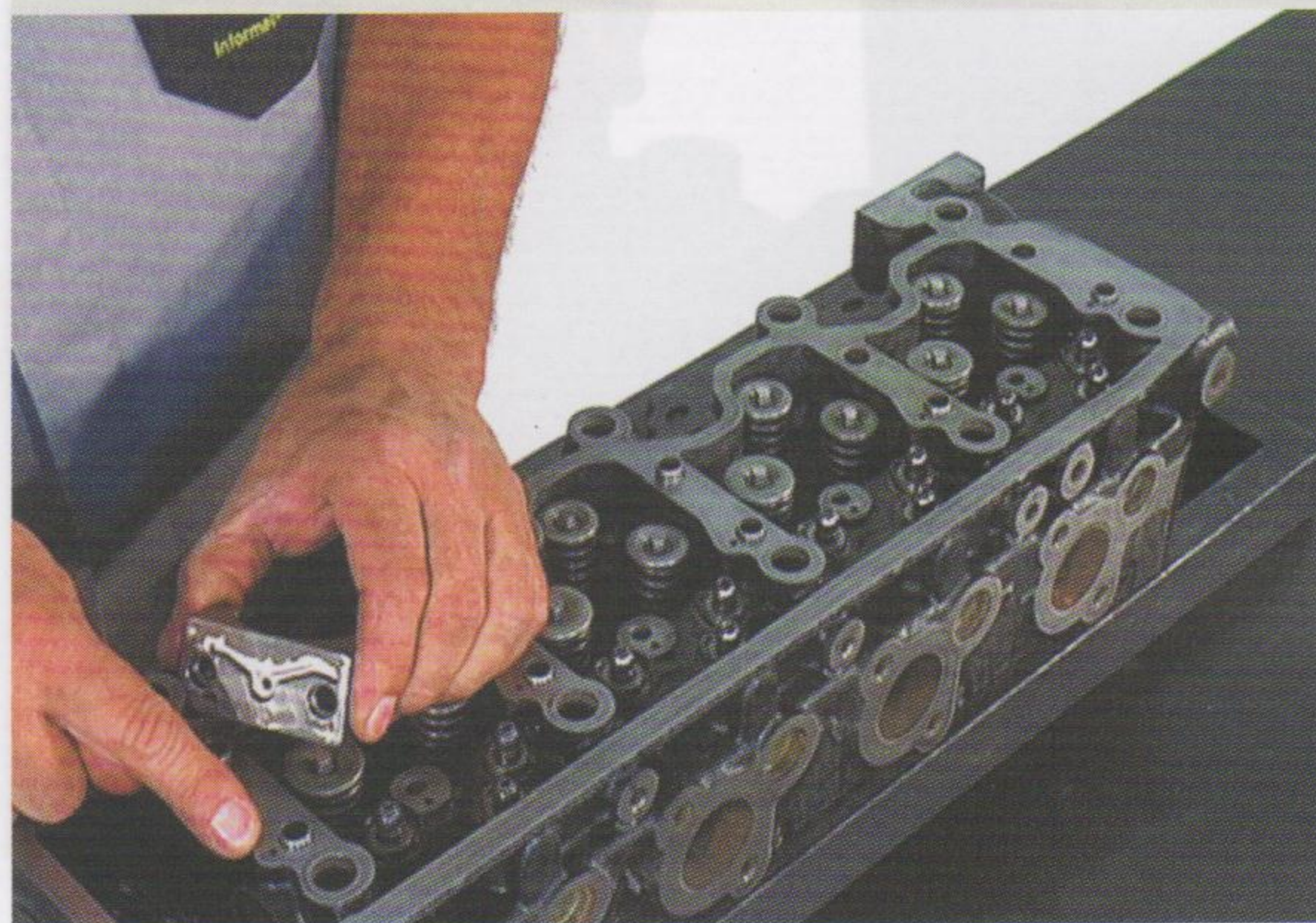
Fig.9 - Instalação dos mancais
