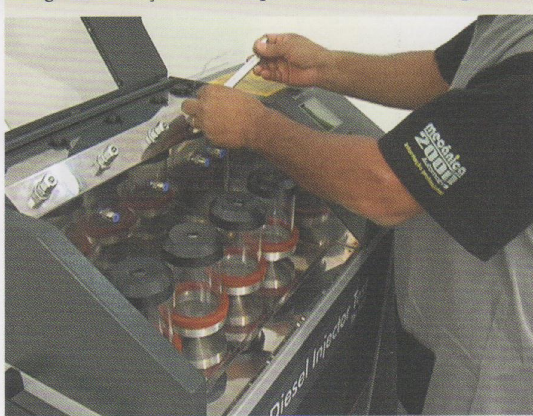
Fig.2 - Remoção dos tampões da linha de alta pressão
