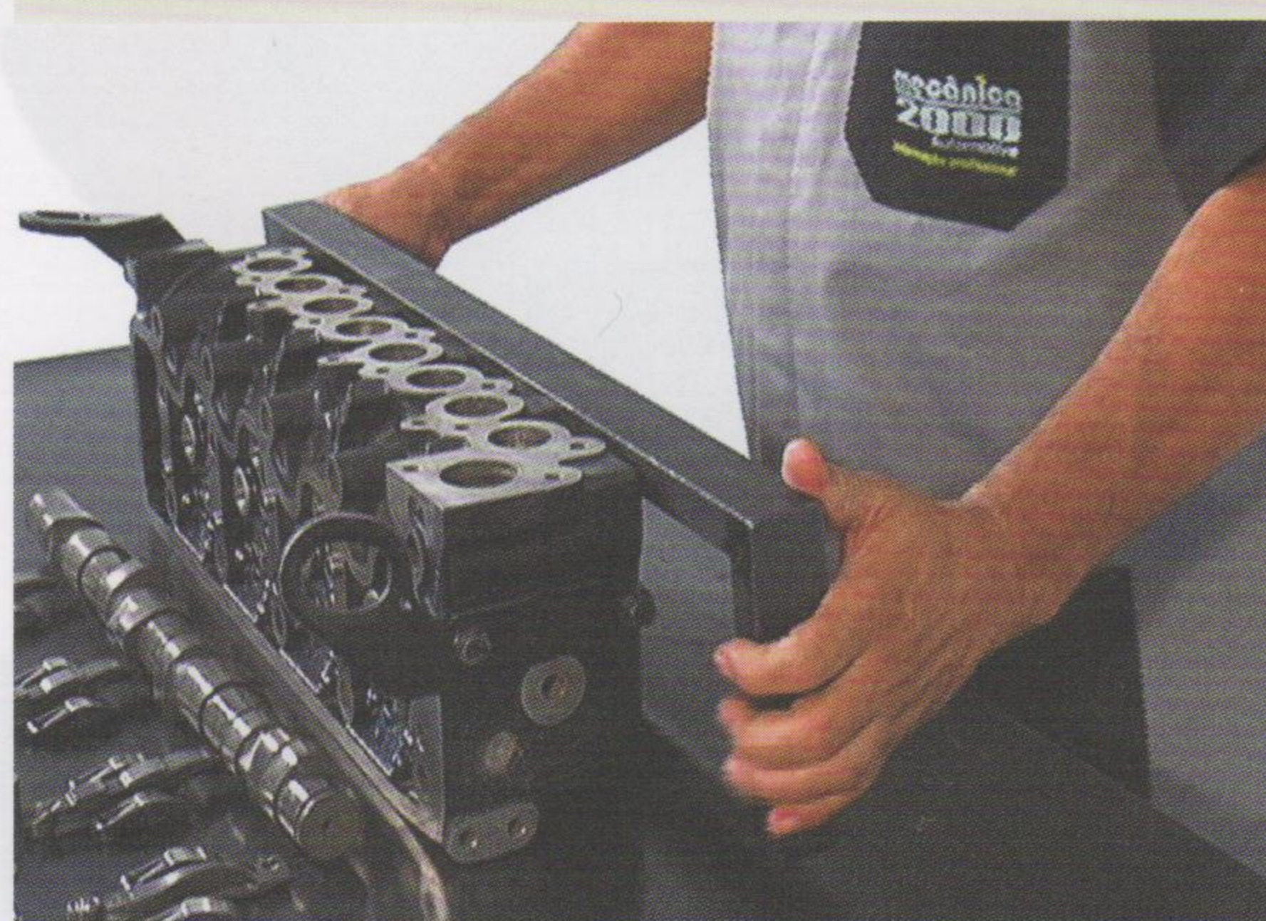
Fig.13 - Remoção da base de apoio
