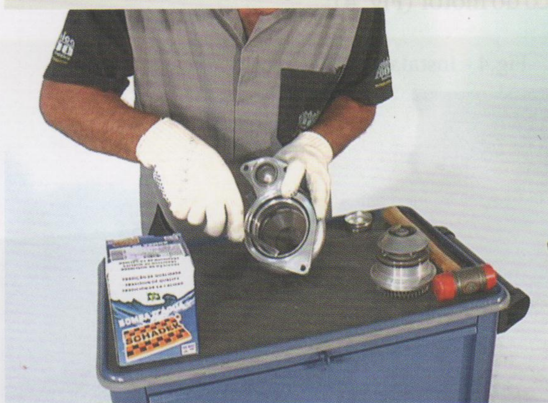
Fig.2 - Remoção do anel de vedação
