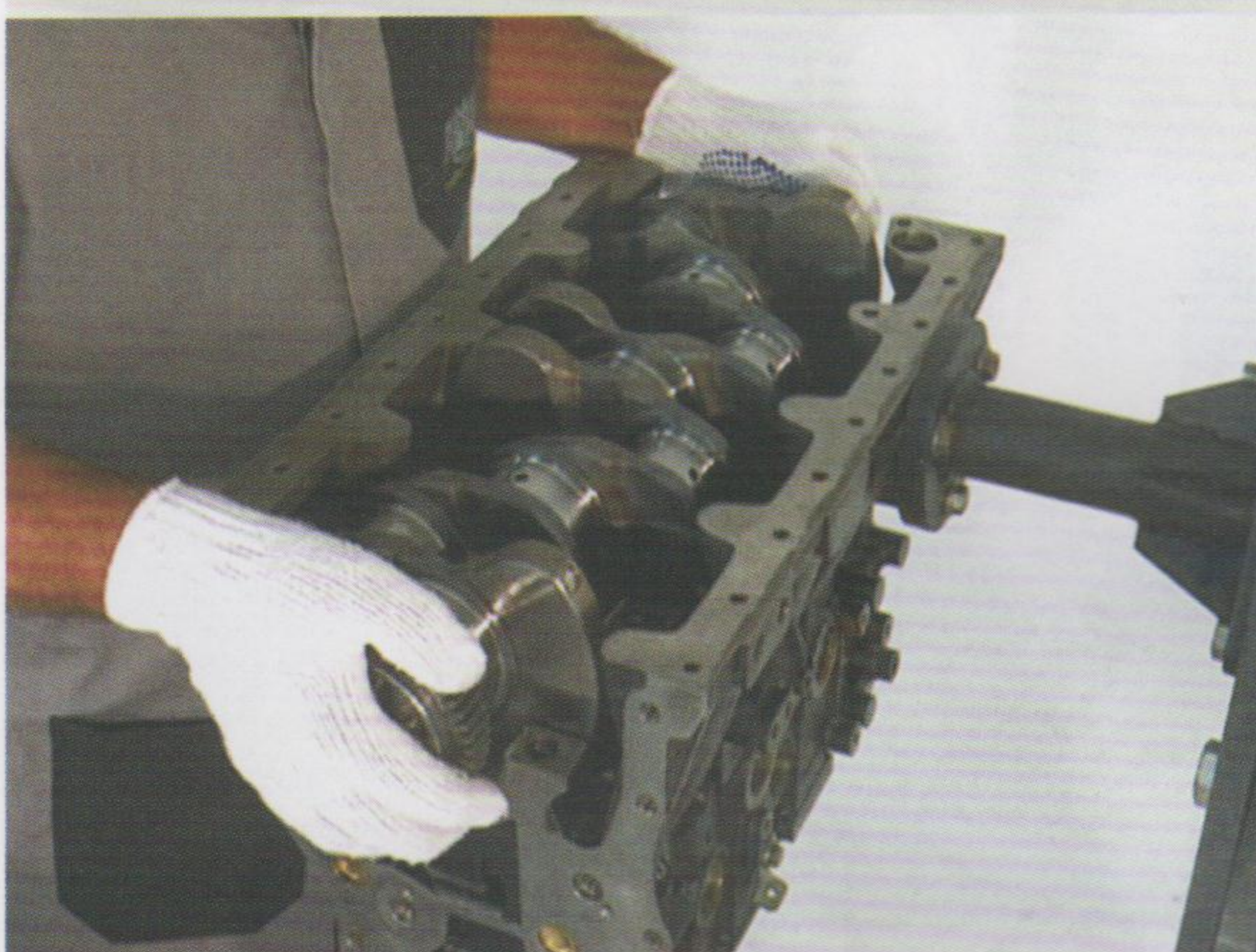
Fig.10 - Instalação da árvore de manivela
