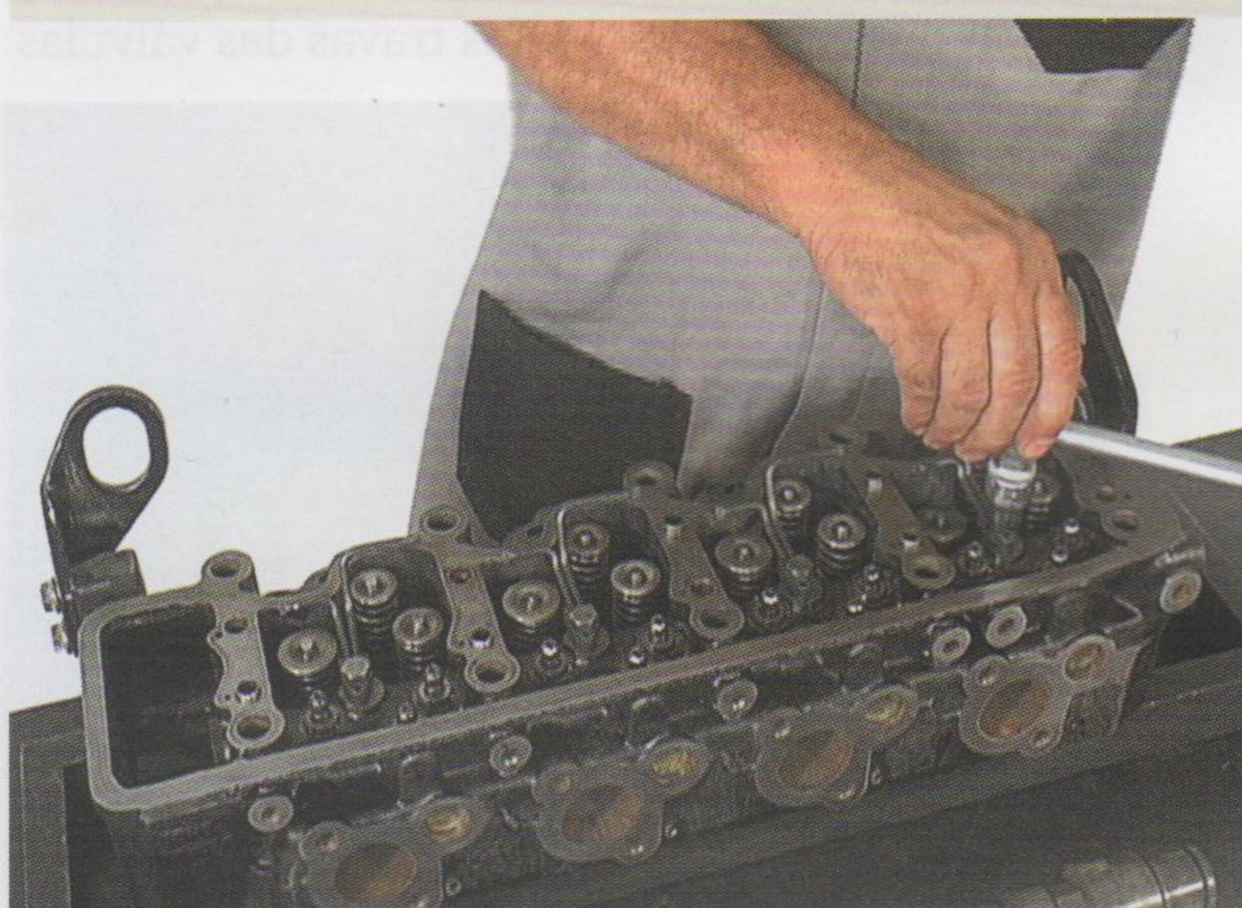
Fig.12 - Remoção dos tubos de lubrificação dos balancins
