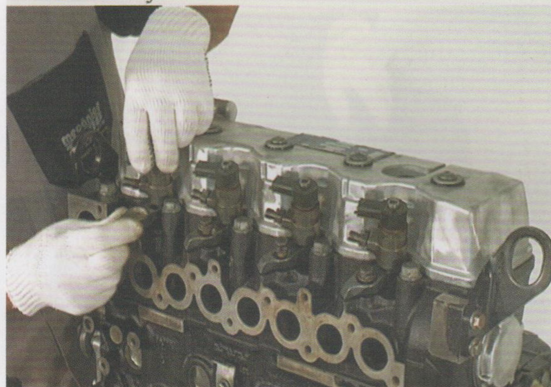
Fig.1 - Instalação dos anéis de vedação dos bicos injetores
