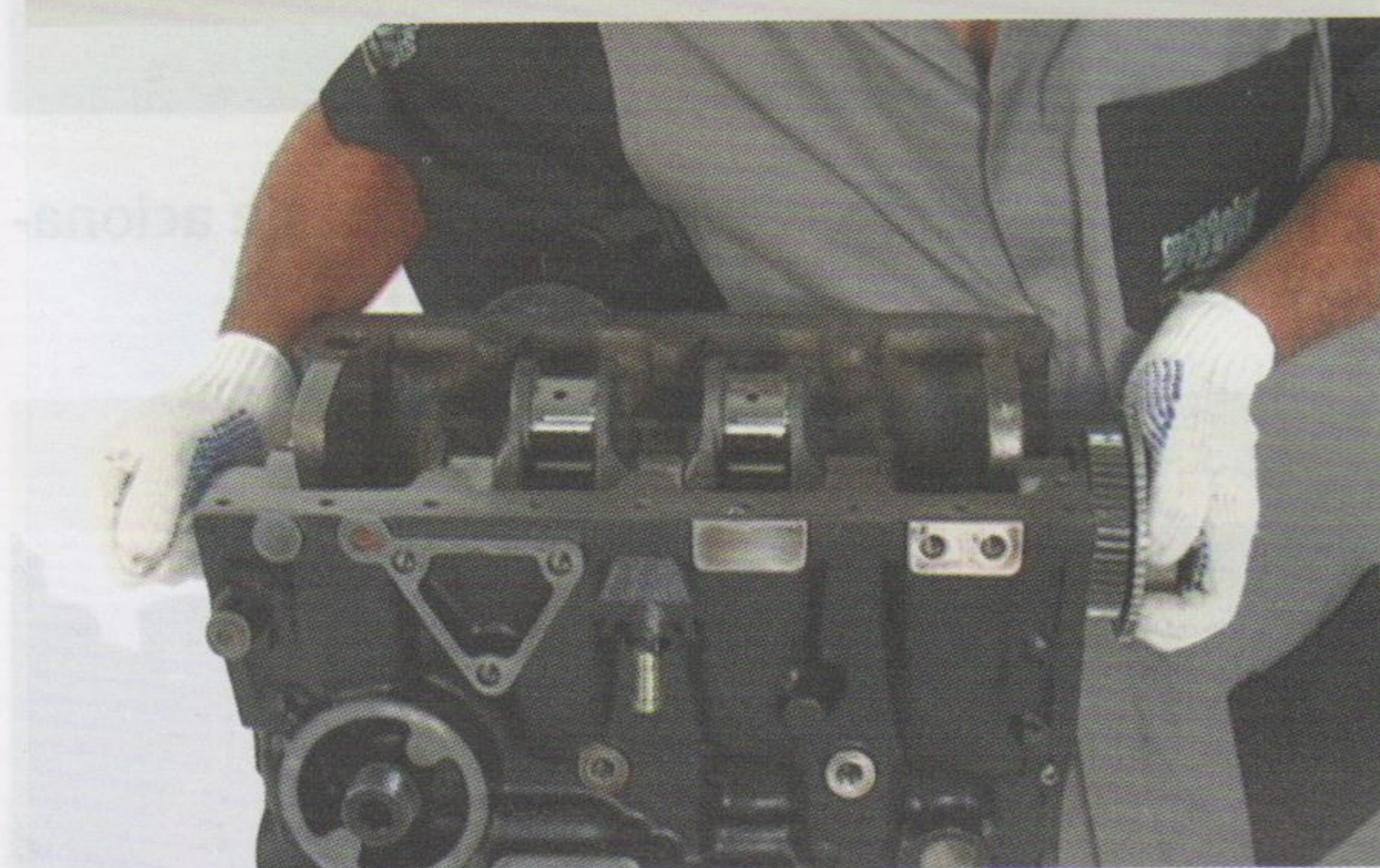
Fig.41 - Remoção da árvore de manivelas
