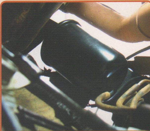
Reservatório de vácuo junto à suspensão dianteira direita também faz parte do sistema 4x4
