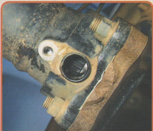
Roda dentada para o sistema ABS junto ao semieixo do diferencial traseiro
