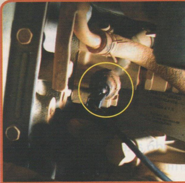
Interruptor de pressão está localizado logo abaixo do filtro do lubrificante
