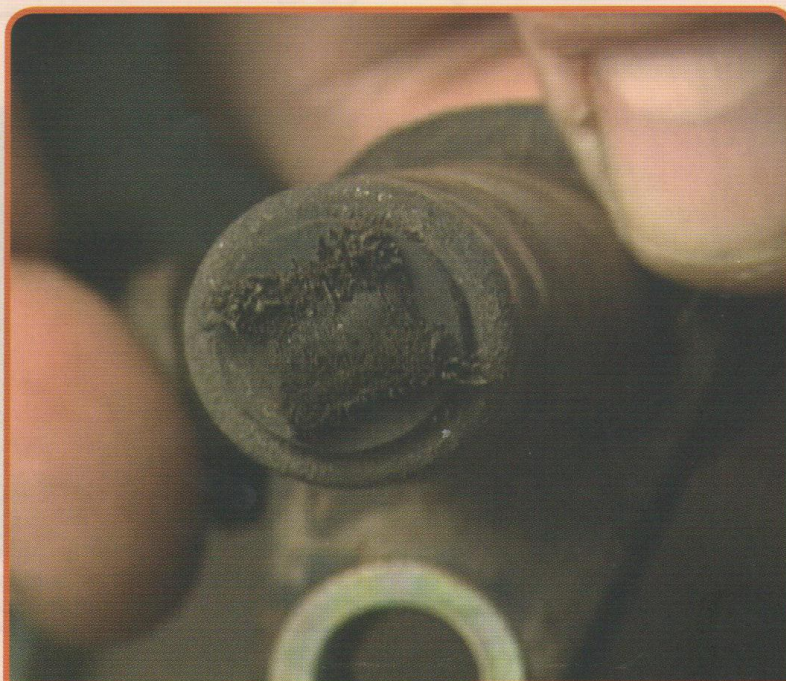
Sujeira no sensor de velocidade da roda pode gerar falhas no sistema ABS
