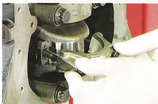
Fig.15 - Instalação das capas
