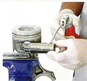
Fig.3 - Montagem do pino
