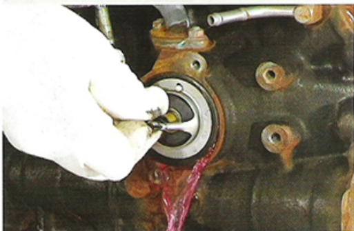
Fig.19 - Remoção da válvula termostática
