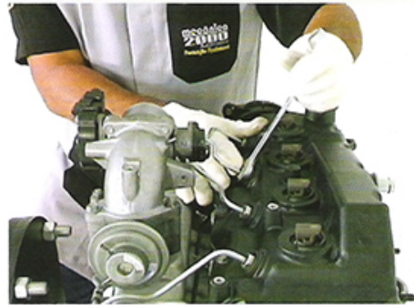
Fig.6 - Apertando a tubulação
