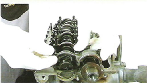
Fig.101 - Remoção das capas dos mancais
