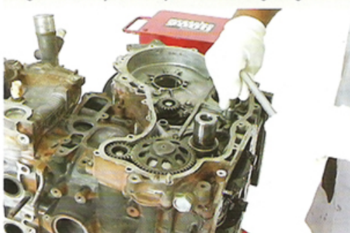
Fig.85 - Remoção do alojamento das engrenagens
