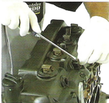
Fig.93 - Remoção das borrachas de vedação
