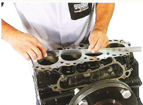
Fig.2 - Medição da planicidade
