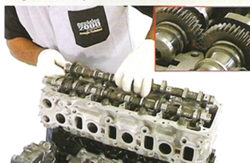
Fig.10 - Instalação dos comandos
