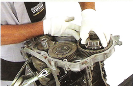
Fig.5 - Instalação engrenagem da bomba
