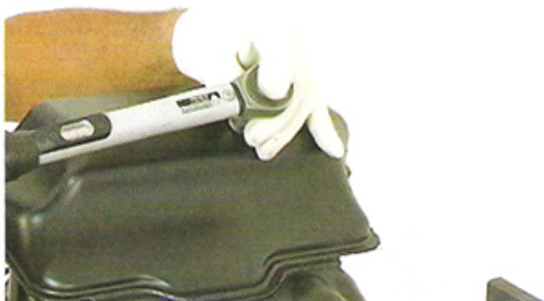
Fig.4 - Instalação do bujão
