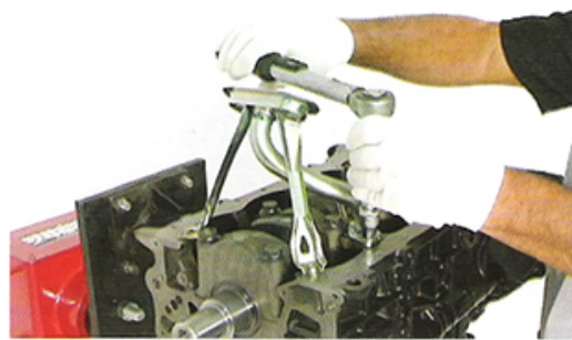
Fig.1 - Instalação do tubo pescador
