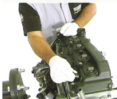
Fig.2 - Instalação das vedações
