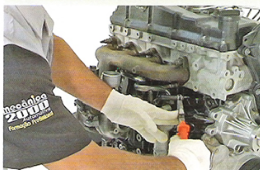
Fig.5 - Instalação das abraçadeiras
