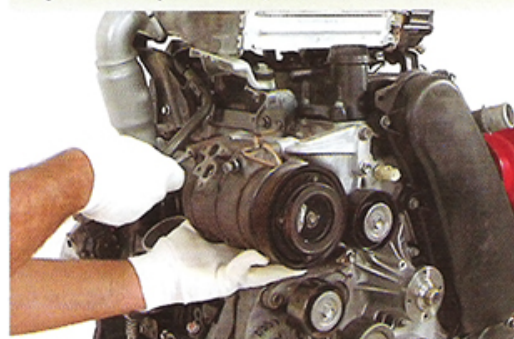
Fig.4 - Instalação do compressor
