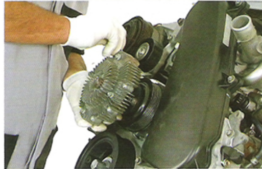
Fig.3 - Instalação do cubo da hélice
