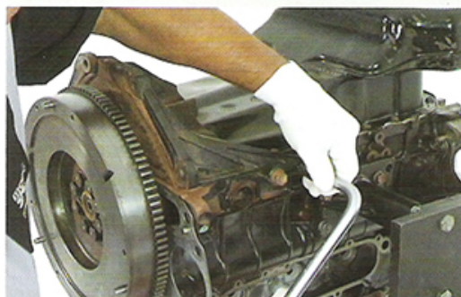
Fig.79 - Remoção dos suportes laterais
