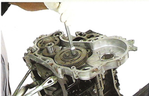
Fig.4 - Instalação dos parafusos de fixação
