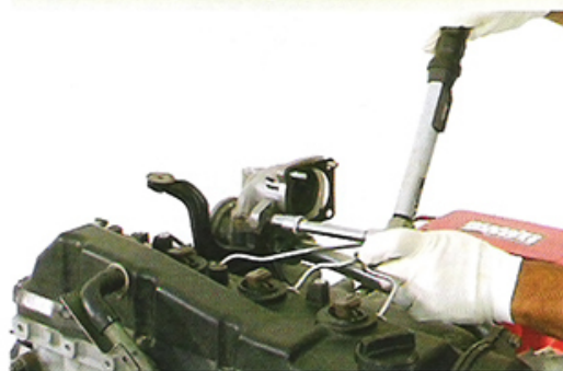
Fig.3 - Instalação do suporte
