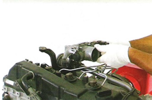
Fig.4 - Reinstalação da borboleta
