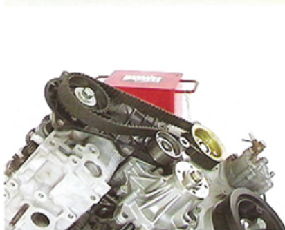
Fig.2 - Instalação da correia
