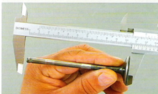
Fig.3 - Medição das válvulas
