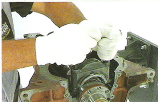
Fig.123 - Remoção das capas dos mancais
