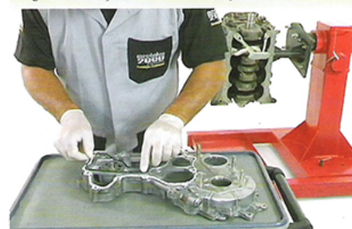
Fig.5 - Instalação do anel de vedação
