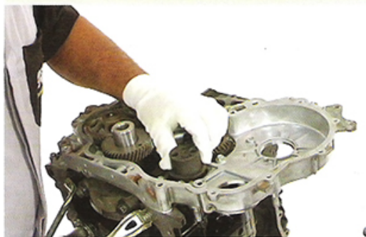
Fig.2 - Instalação do mancal de apoio
