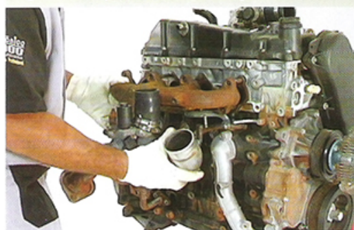
Fig.16 - Remoção do coletor de escapamento
