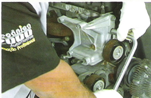
Fig.7 - Remoção do suporte do compressor
