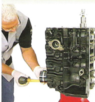
Fig.14 - Instalação dos êmbolos
