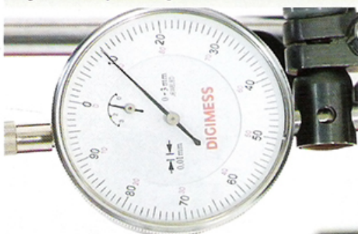
Fig.1 - Verificação da folga
