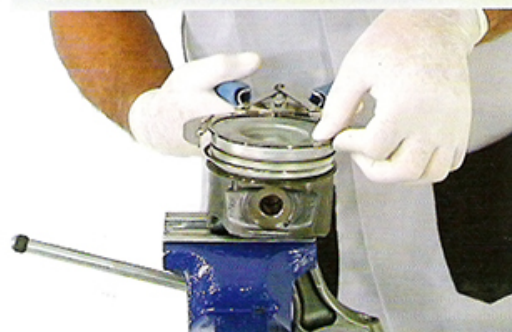
Fig.5 - Instalação dos anéis
