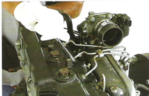
Fig.21 - Remoção da conexão dos injetores
