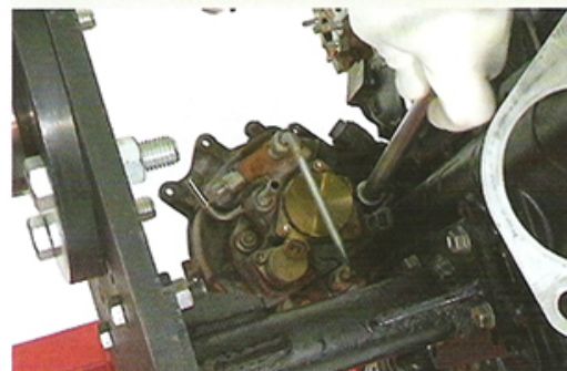
Fig.72 - Remoção da bomba de combustível
