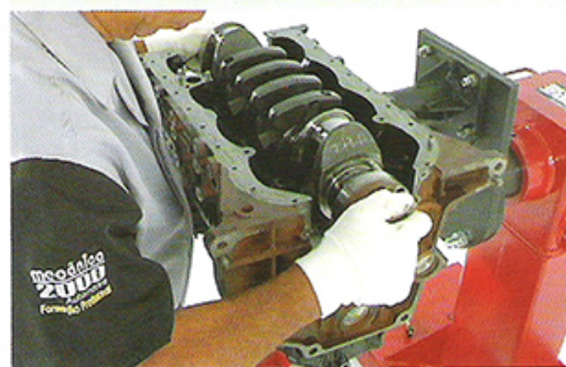
Fig.125 - Remoção da árvore de manivelas
