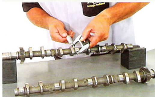
Fig.6 - Medição dos mancais
