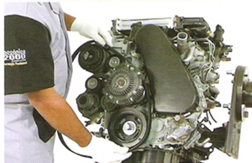
Fig.4 - Instalação da correia
