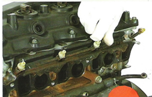
Fig.31 - Remoção das porcas de isolamento
