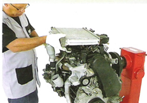
Fig.9 - Instalação do intercooler
