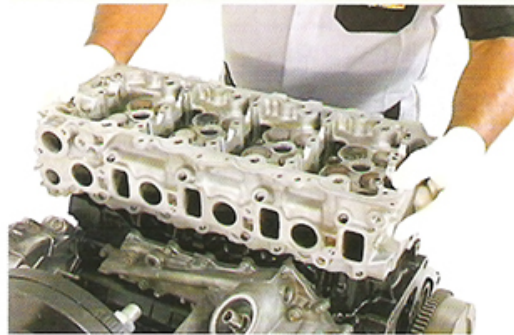
Fig.3 - Instalação do cabeçote
