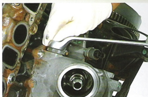
Fig.41 - Remoção da válvula by pass
