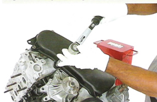
Fig.13 - Instalação da tampa
