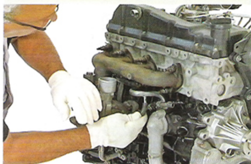
Fig.4 - Instalação dos tubos de arrefecimento
