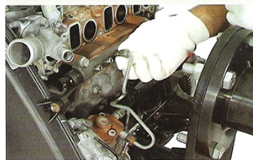
Fig.36 - Remoção dos tubos do common rail
