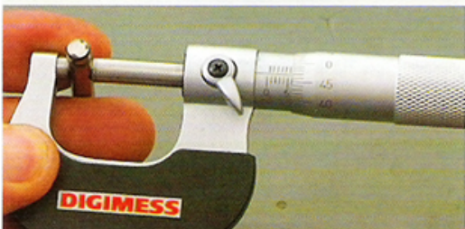
Fig.5 - Medição das válvulas
