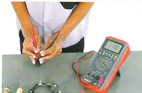
Fig.3 - Medindo a resistência
