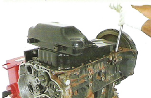
Fig.80 - Remoção do carter
