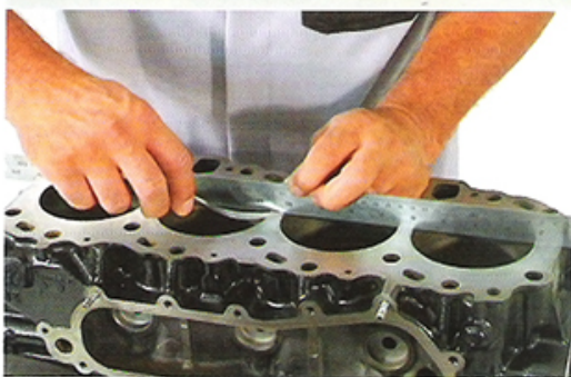
Fig.1 - Medição da planicidade
