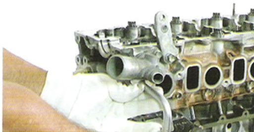
Fig.106 - Remoção do bocal
