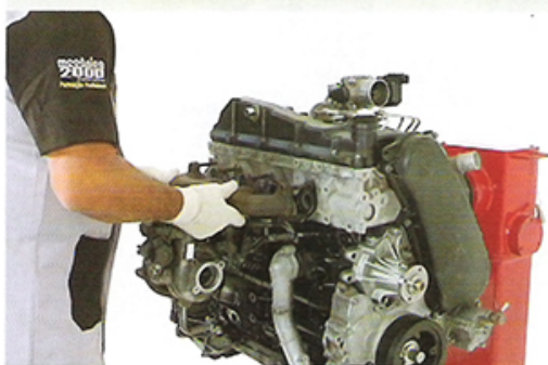
Fig.2 - Instalação do escapamento
