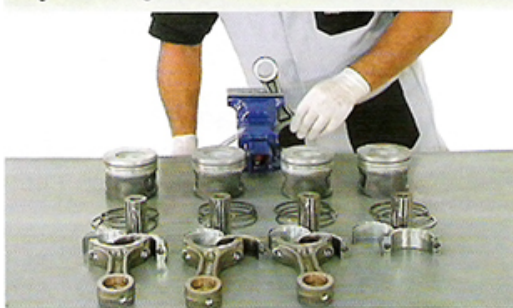
Fig.1 - Montagem dos êmbolos
