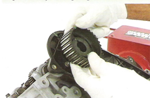
Fig.3 - Instalação da engrenagem
