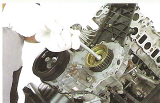
Fig.7 - Instalação da engrenagem
