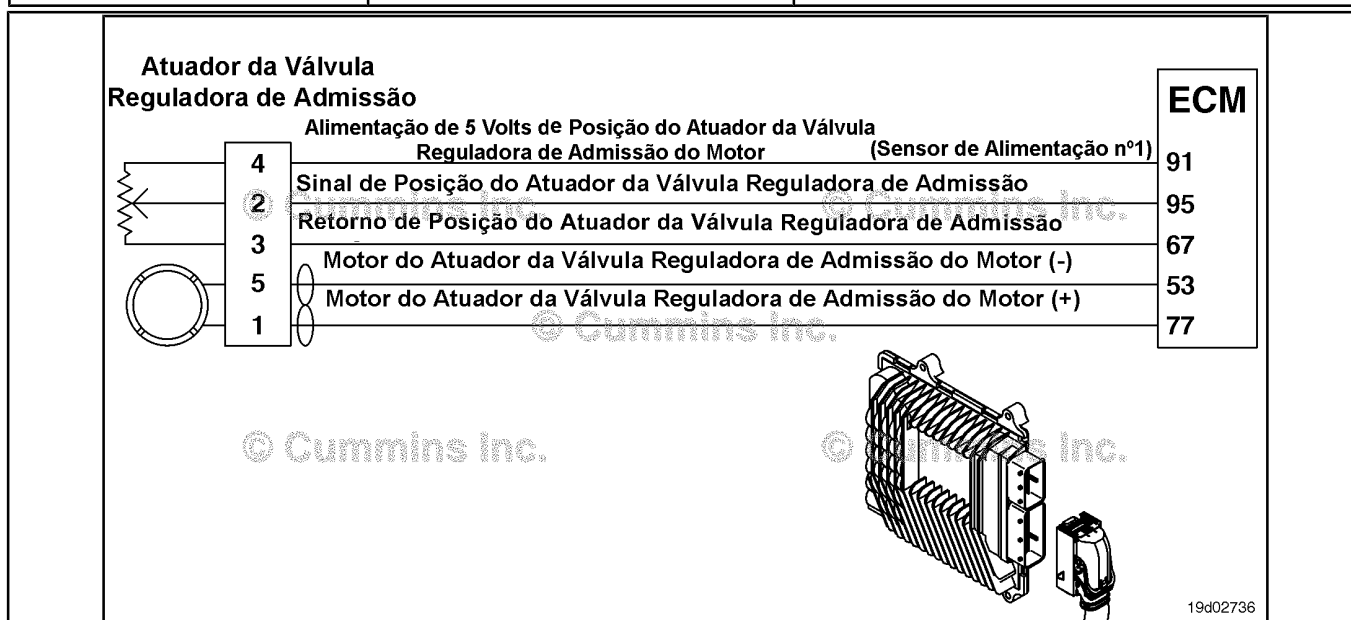
ISF2.8 CM2220 E - Circuito do Sensor da Posição do Atuador da Válvula Reguladora de Admissão do Motor
