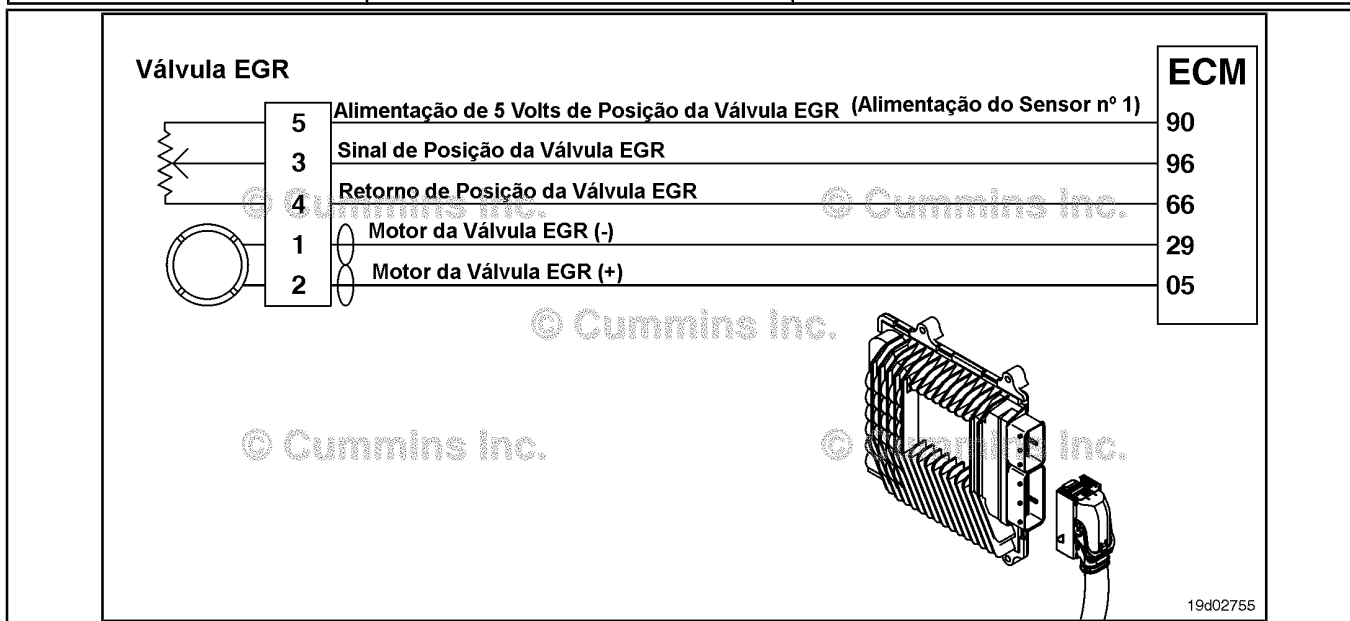
ISF2.8 CM2220 E - Circuito de Controle da Válvula EGR
