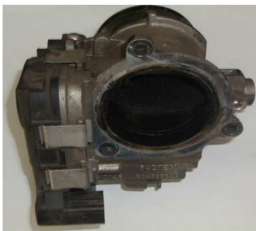
Detalhe do corpo de borboleta da EGR totalmente carbonizado e bloqueado pela carbonização
