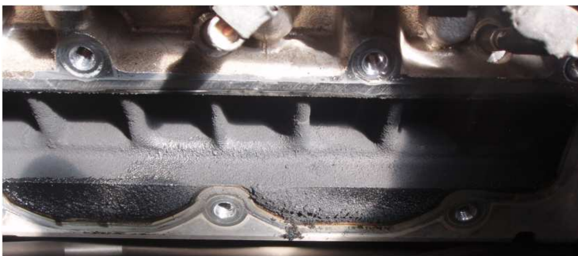
Coletor de admissão totalmente carbonizado, onde até o MAP ficou inoperante.
