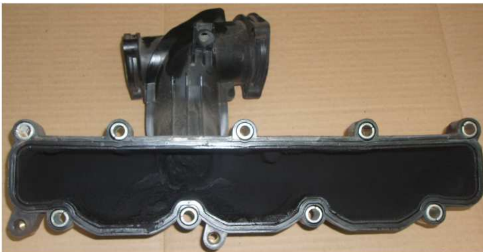
Coletor de admissão totalmente carbonizado, onde até o MAP ficou inoperante.
